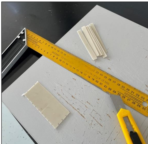
Slika 19. Rezanje epruveta dimenzija 10 × 100 mm, debljine 1 mm
