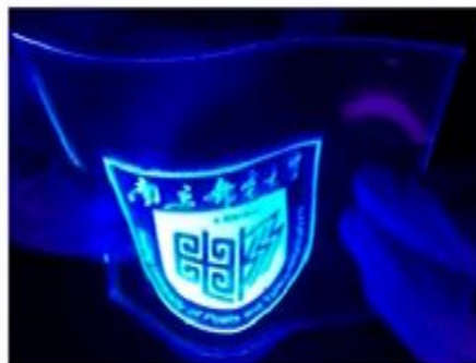
Slika 2.8. Prikaz organske LED diode i inkjet ispisanim emisijskim slojem na fleksibilnom supstratu [4]
