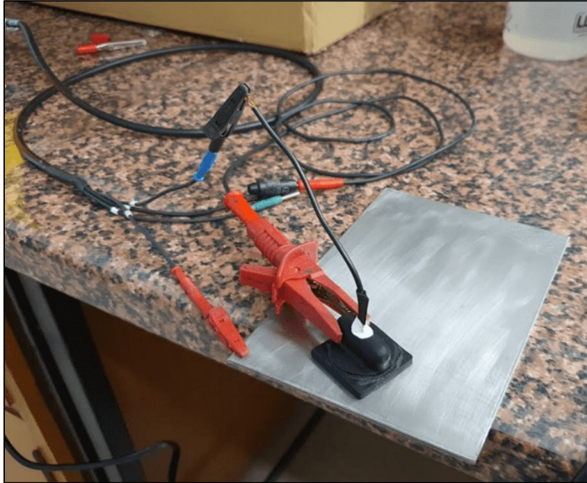
Slika 24: Snimanje impedancijskih spektara i potencijala otvorenog kruga na referentnoj pločici 1
