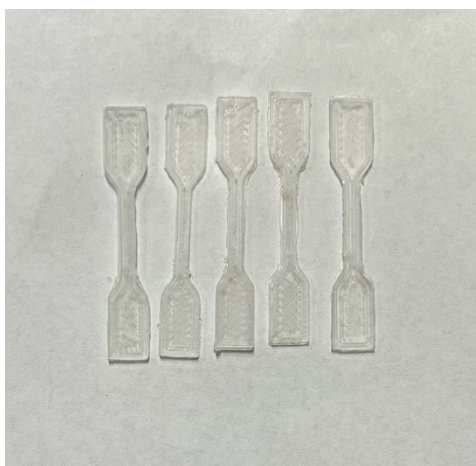
Slika 24. Prikaz 3D-ispisanih epruveta od PVB pod 0° debljine sloja 0,05 mm
