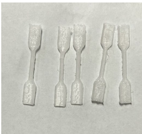
Slika 23. Prikaz 3D-ispisanih epruveta od PVB pod 45° debljine sloja 0,20 mm
