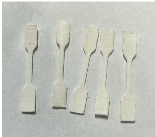
Slika 27. Prikaz 3D-ispisanih epruveta od TPU pod 45° debljine sloja 0,20 mm
