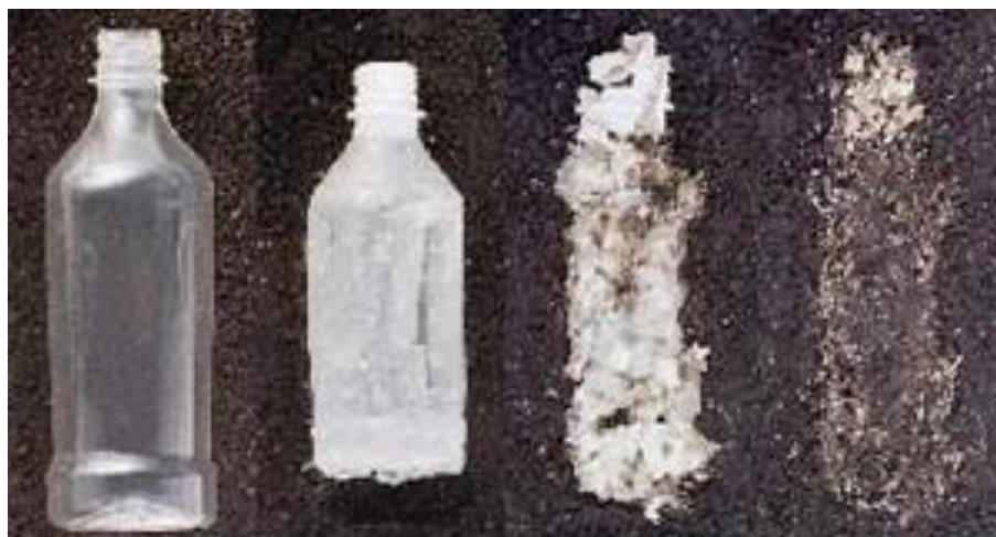
Slika 9. Razgradnja PHA boce u tlu tijekom 2 mjeseca [26]
