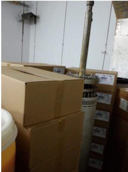
Slika 12. Izvor ^{60}\text{Co} okružen materijalom kojeg treba sterilizirati [19]
