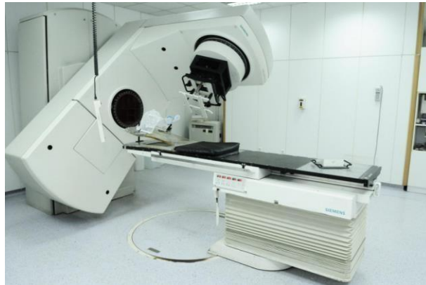
Slika 15. Linearni akcelerator korišten u Zadarskoj bolnici kao izvor zračenja za radioterapiju [26]
