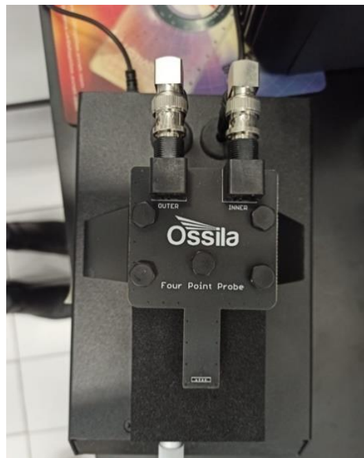
Slika 18. Ossila Four Point Probe instrument za mjerenje otpora u četiri točke
