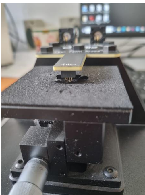
Slika 23. Prikaz mjerenja otpora filma
