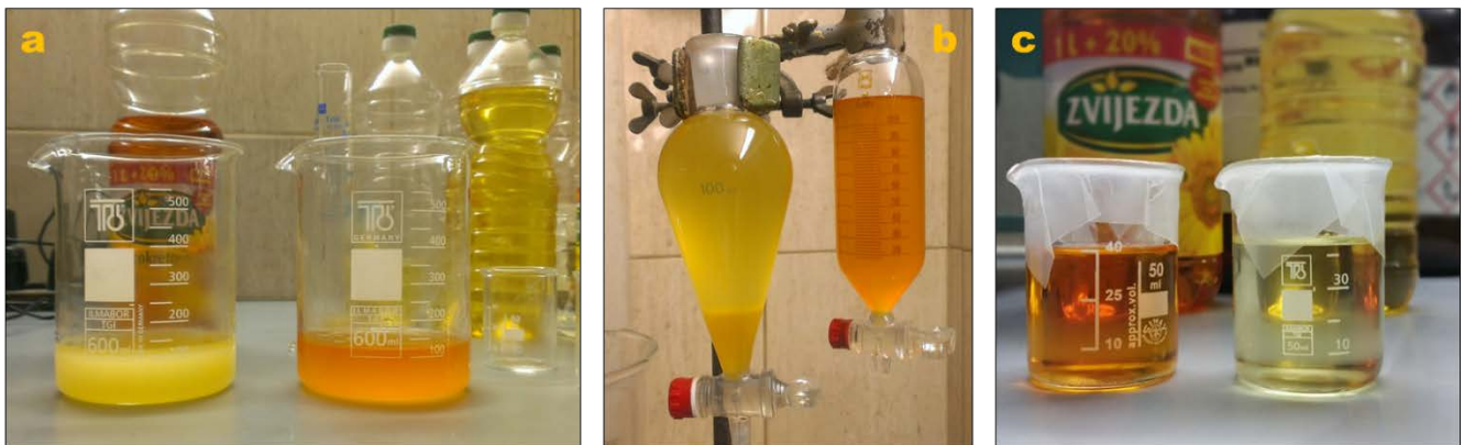
Slika 10 Sinteza biodizela iz otpadnog suncokretovog ulja: a) Reakcijska smjesa u čaši; b) Reakcijska smjesa u lijevku; c) biodizel nakon separacije (gornja faza)
