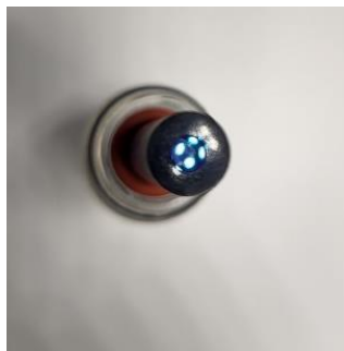
Slika 23: GC elektroda modificirana berlinskim modrilom (60 min depozicije)
