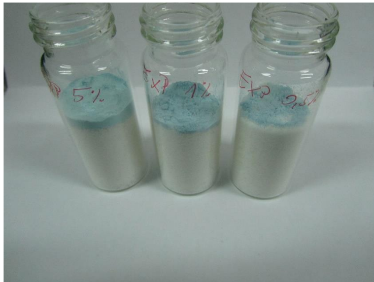
Slika 6 Priprema bočica napunjenih usitnjenim PLA i Expancelom za homogenizaciju na tresilici
