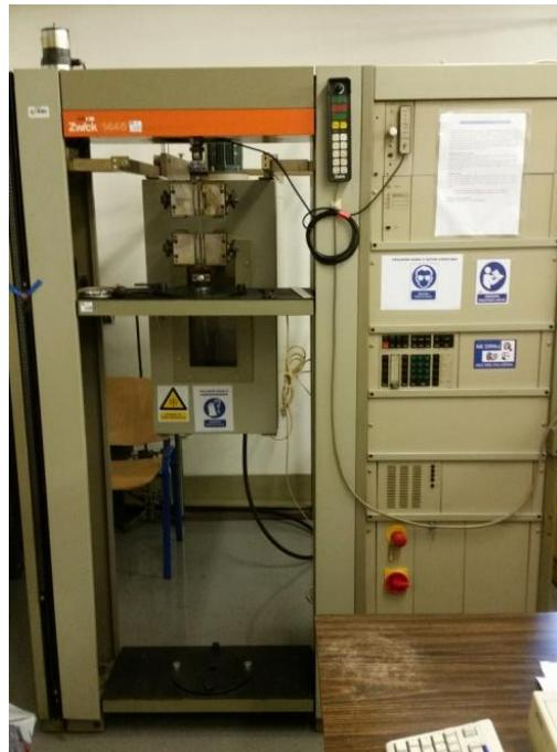
**Slika 12** Mehanička kidalica Zwick
