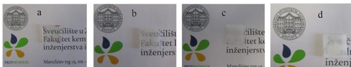
Slika 28 Usporedba prozirnosti uzorka prije te nakon bubrenja: a) uzorka koji nije bubren b) voda c) toluen d) ksilen
