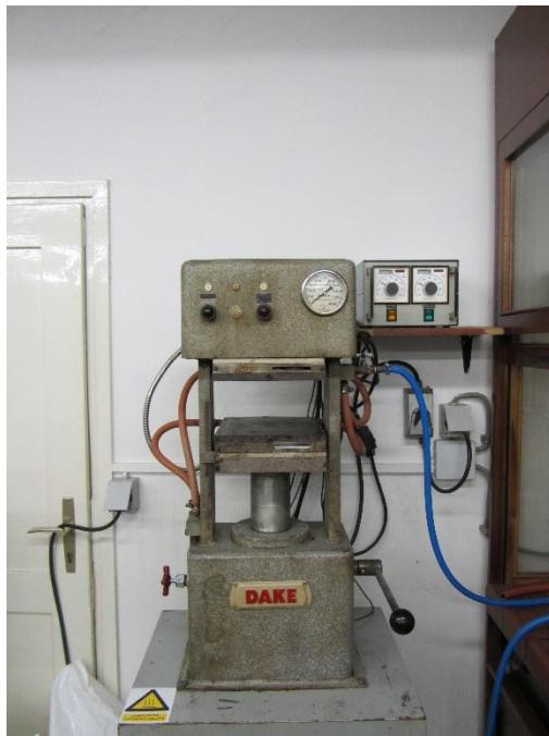
**Slika 8** Hidraulička preša Dake
