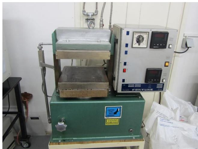
**Slika 9** Hidraulička preša Fontune
