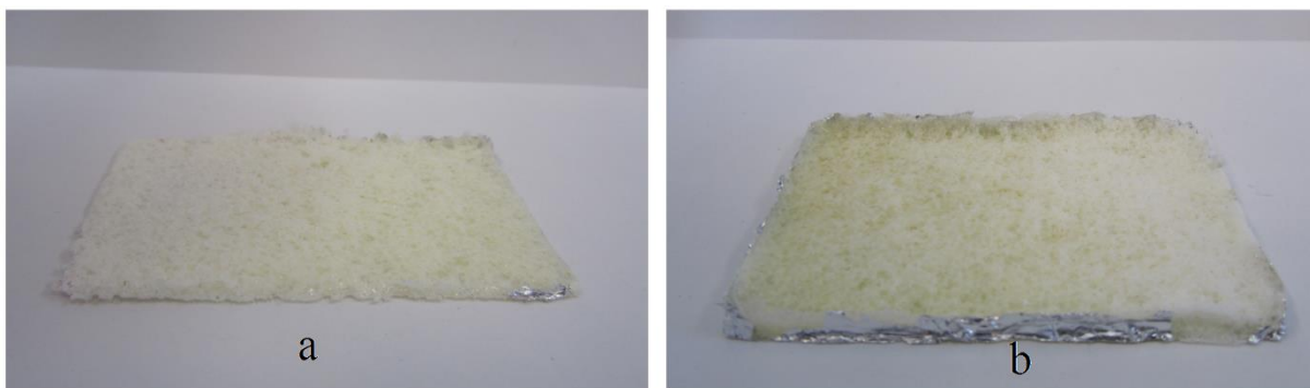
Slika 13 Ekspandirani uzorak s 0,5 mas % Expancela pri punjenju kalupa s 12 g PLA (a) i sa 16 g PLA (b)
