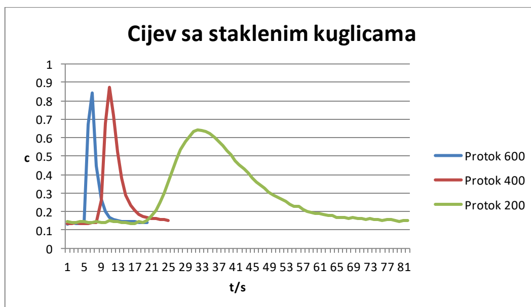
Slika 15. RZV krivulje dobivene pri različitim protocima i volumenu traseru 6,3 u tri različite cijevi
