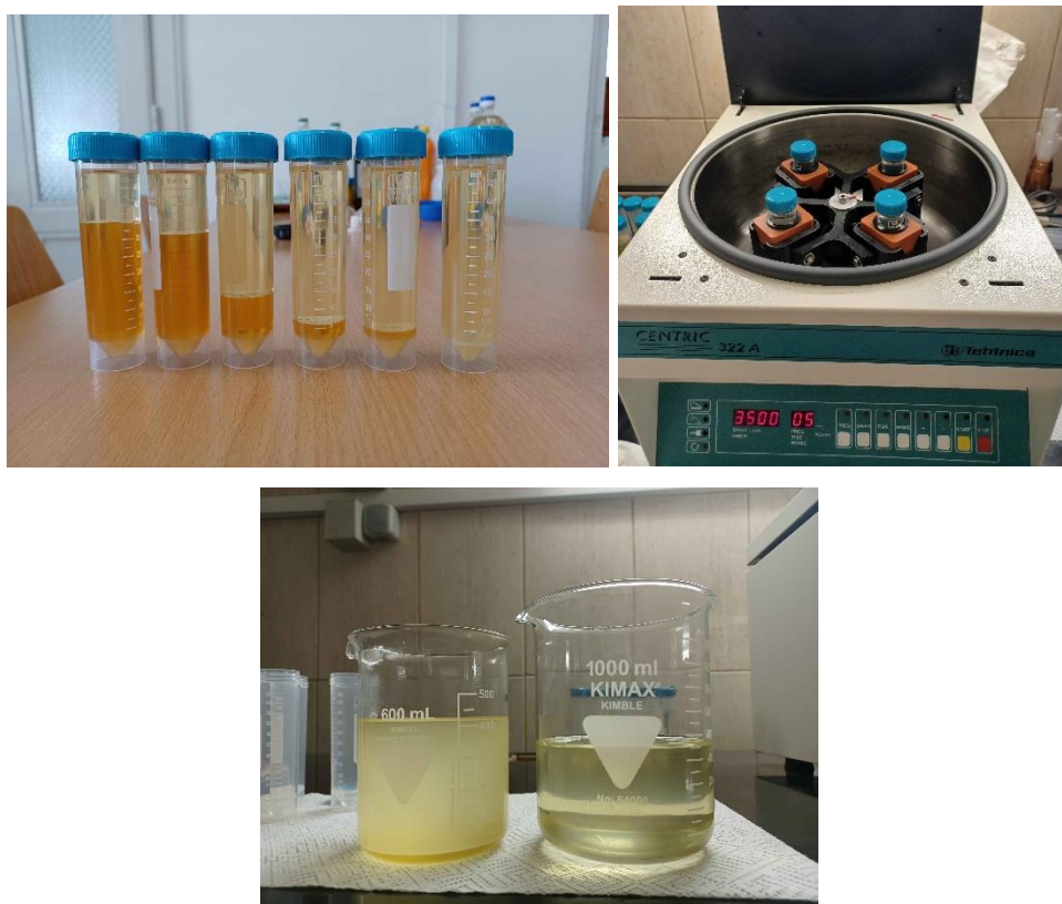
Slika 8. Odvajanje biodizela i glicerola nakon centrifugiranja
