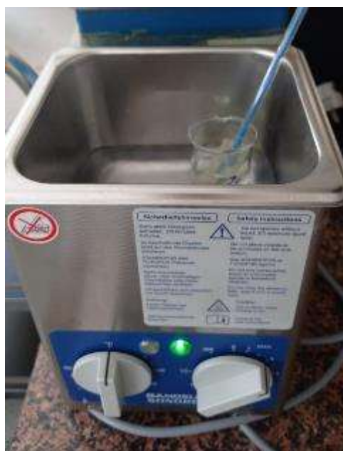
Slika 3.1. Obrada radne elektrode u kupelji
