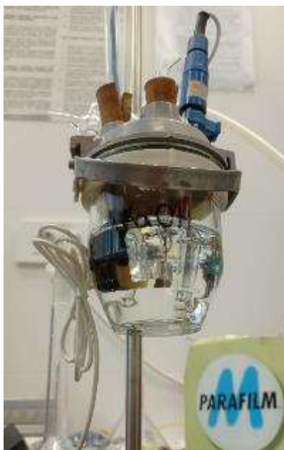
Slika 3.2.. Dušiciranje elektrolita u troelektrodnom mjernom sustavu.
