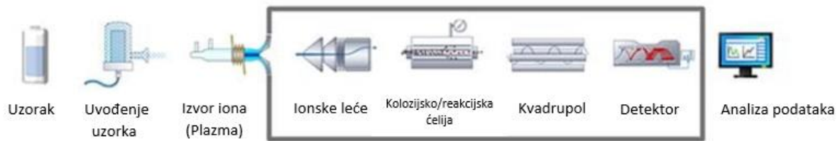
Slika 4. Shematski prikaz dijelova ICP-MS instrumenta [49]
