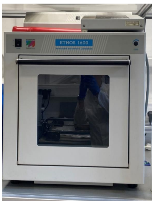
Slika 19. Prikaz Milestone ETHOS 1600 mikrovalne pečnice
