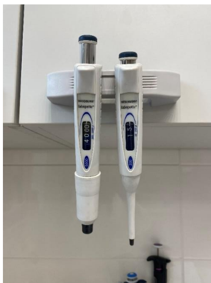
Slika 17. Prikaz Hirschmann pipete od 500 – 5000 \mu\text{L} (lijevo) i od 20 – 200 \mu\text{L} (desno)
