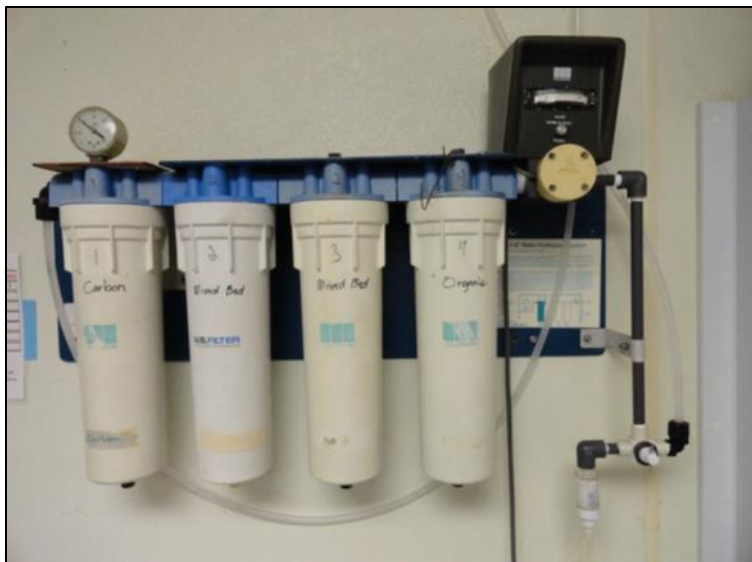
Slika 6. Mili-Q uređaj za dobivanje ultračiste vode
