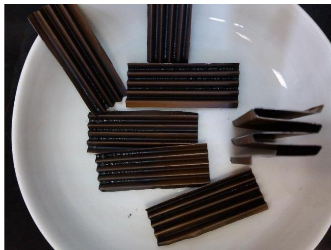
**Slika 3.3.** Pripremljeni monolitni katalizatori
