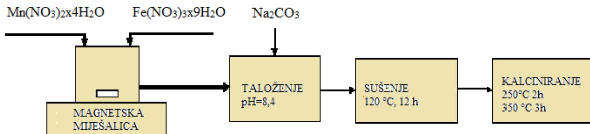
**Slika 3.1.** Shematski prikaz pripreme praškastog Mn-Fe katalizatora
