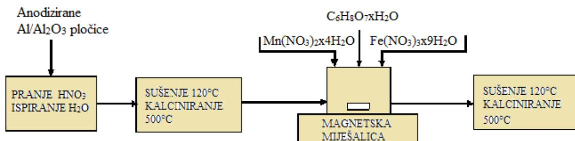
**Slika 3.4.** Shematski prikaz pripreme metalnog monolitnog katalizatora
