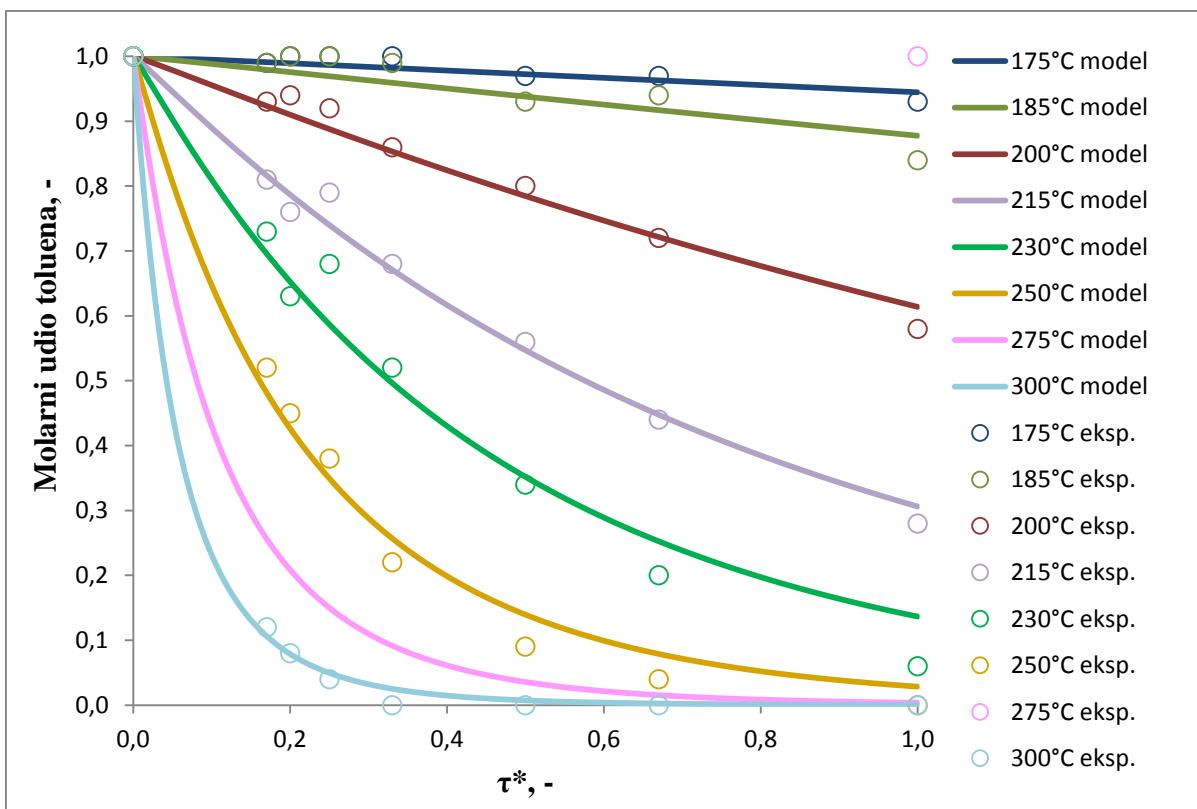
**Slika 5.10.**Usporedba eksperimentalnih rezultata (točke), dobivenih u monolitnom reaktoru, s vrijednostima dobivenim prema pretpostavljenom modelu s međufaznom difuzijom (linije) za različite temperature
