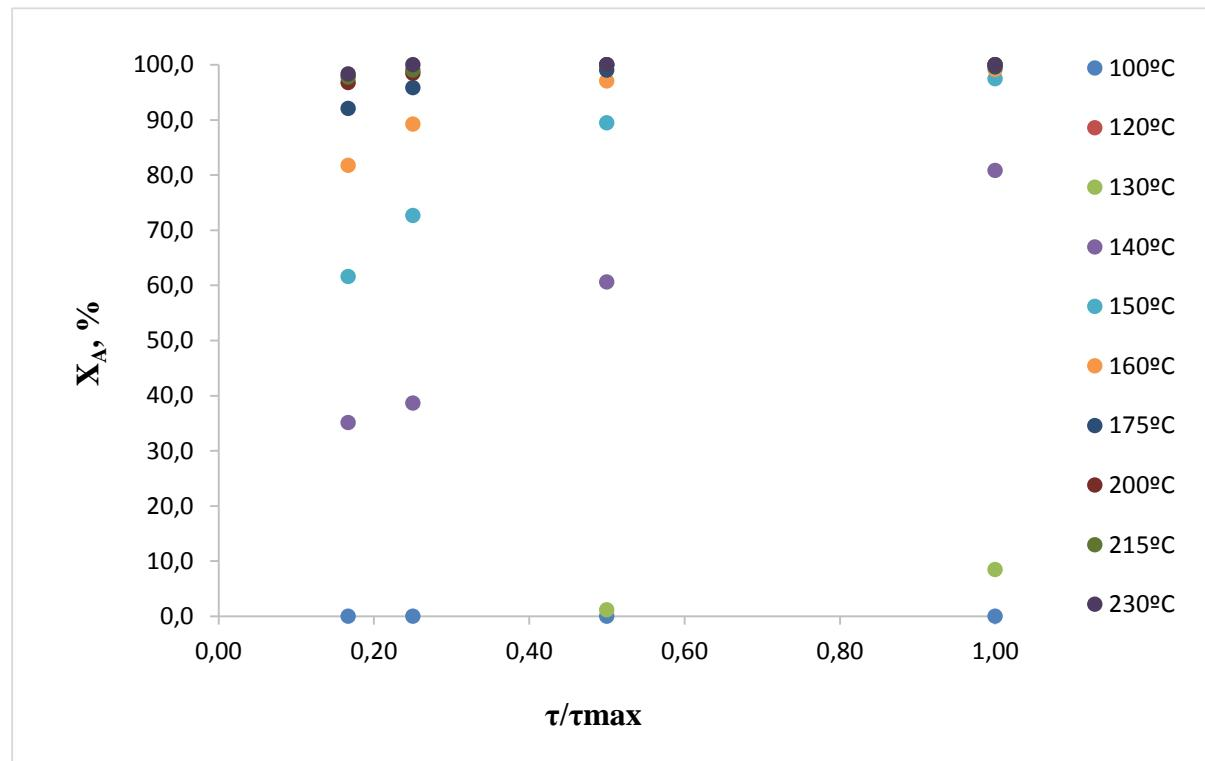
**Slika 5.3.** Utjecaj temperature i normaliziranog prostornog vremena na konverziju toluena u reaktoru s nepokretnim slojem Mn-Fe katalizatora uz konstantnu početnu koncentraciju toluena (korišteni podaci iz tablice 4.3.)
