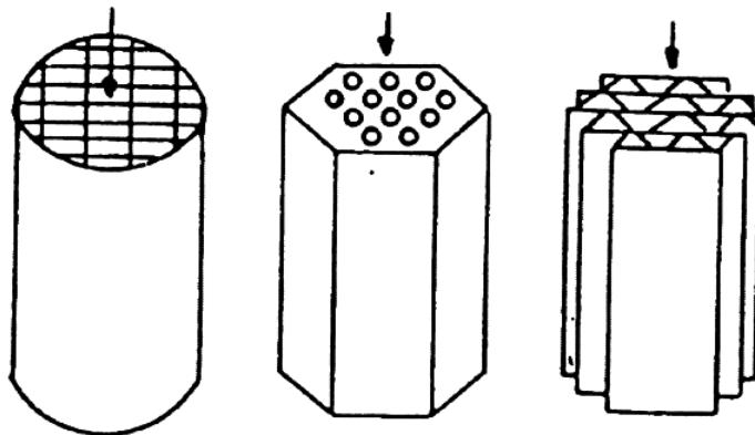
**Slika 2. 5.** Shematski prikaz uobičajenih monolitnih struktura
