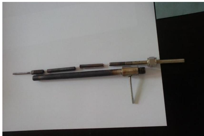
**Slika 3.7.** Punjenje cijevnog reaktora monolitnim katalizatorom
