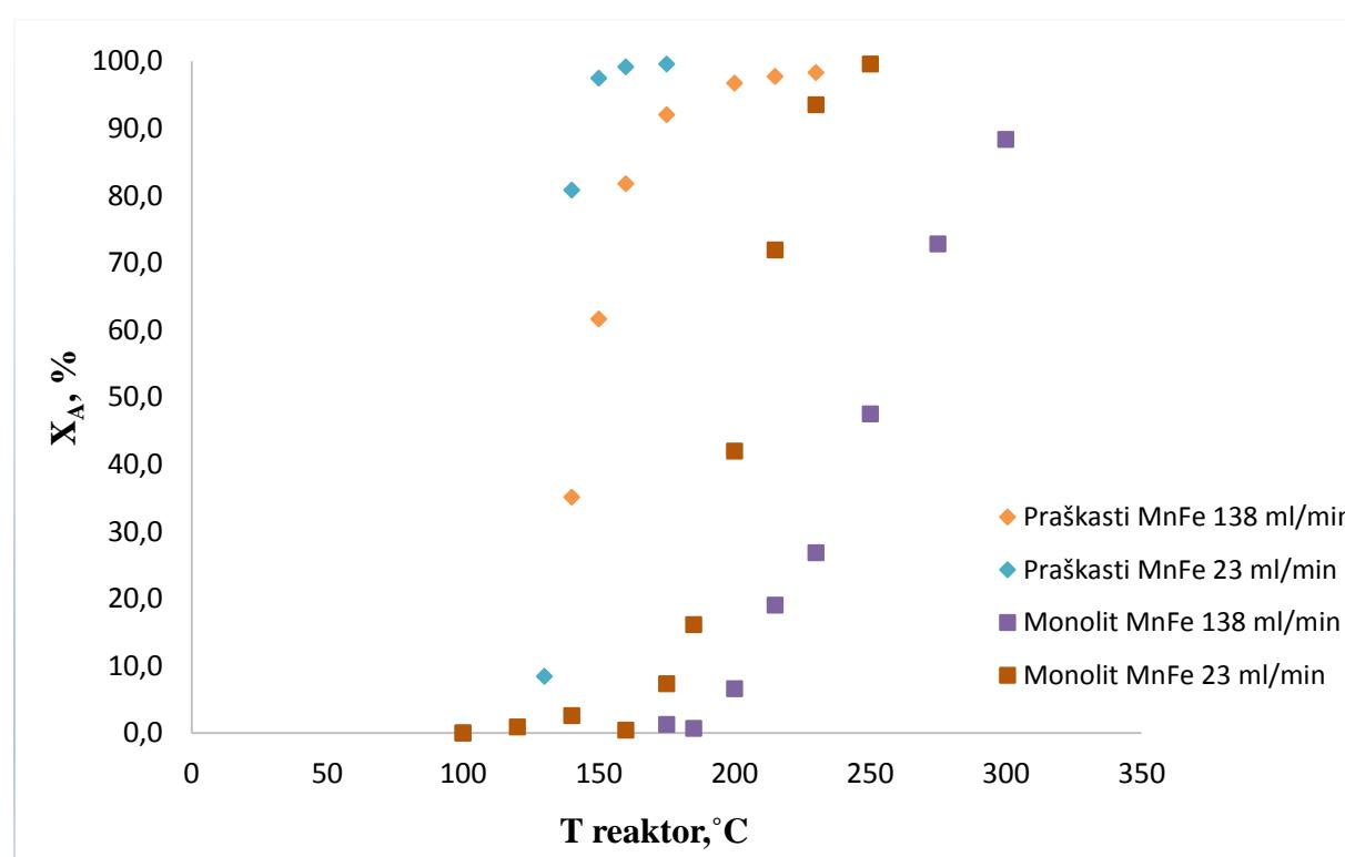
Slika 5.7. Usporedba rezultata dobivenih u cijevnom reaktoru s nepokretnim slojem katalizatora i monolitnom reaktoru pri različitim temperaturama uz konstantnu početnu koncentraciju toluena i  $v_{uk}=138 \text{ mL/min}$  (korišteni su podaci iz tablica 4.3. i 4.4.).
