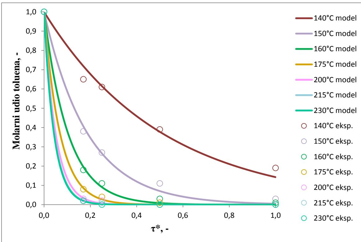
**Slika 5.8.**Usporedba eksperimentalnih rezultata (točke), dobivenih u cijevnom reaktoru sa nepokretnim slojem praškastog katalizatora, s vrijednostima dobivenim prema pretpostavljenom pseudohomogenom modelu (linije) za različite temperature
