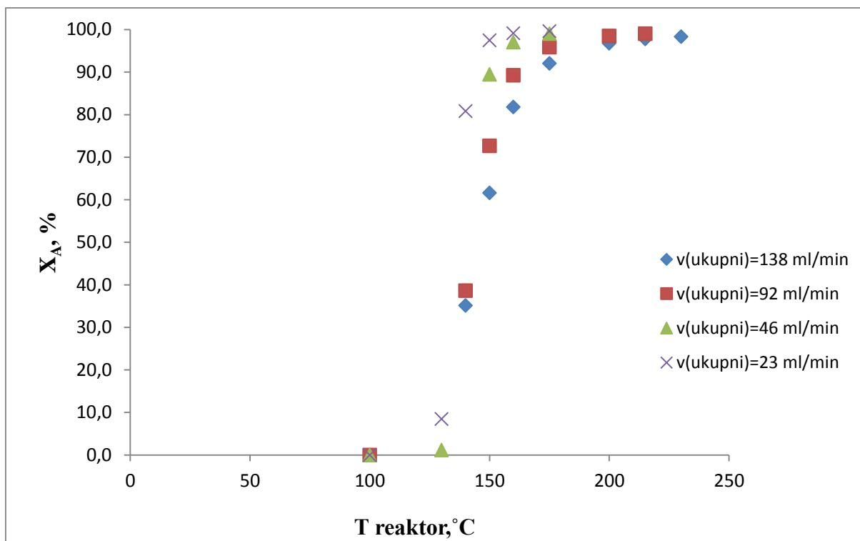
**Slika 5.1.** Utjecaj temperature na konverziju toluena u reaktoru s nepokretnim slojem Mn-Fe katalizatora pri različitim vremenima zadržavanja reakcijske smjese uz konstantnu početnu koncentraciju toluena (korišteni podaci iz tablice 4.3.)
