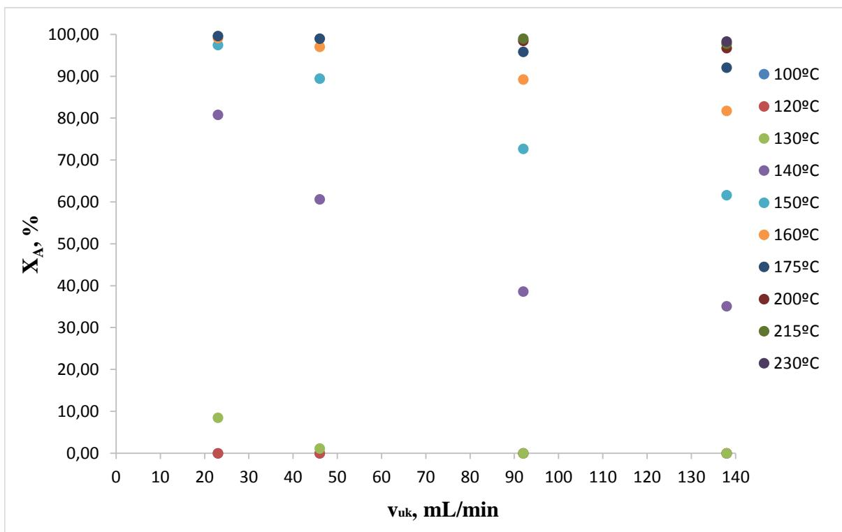
**Slika 5.2.** Utjecaj temperature i ukupnog protoka reakcijske smjese na konverziju toluena u reaktoru s nepokretnim slojem Mn-Fe katalizatora uz konstantnu početnu koncentraciju toluena (korišteni podaci iz tablice 4.3.)
