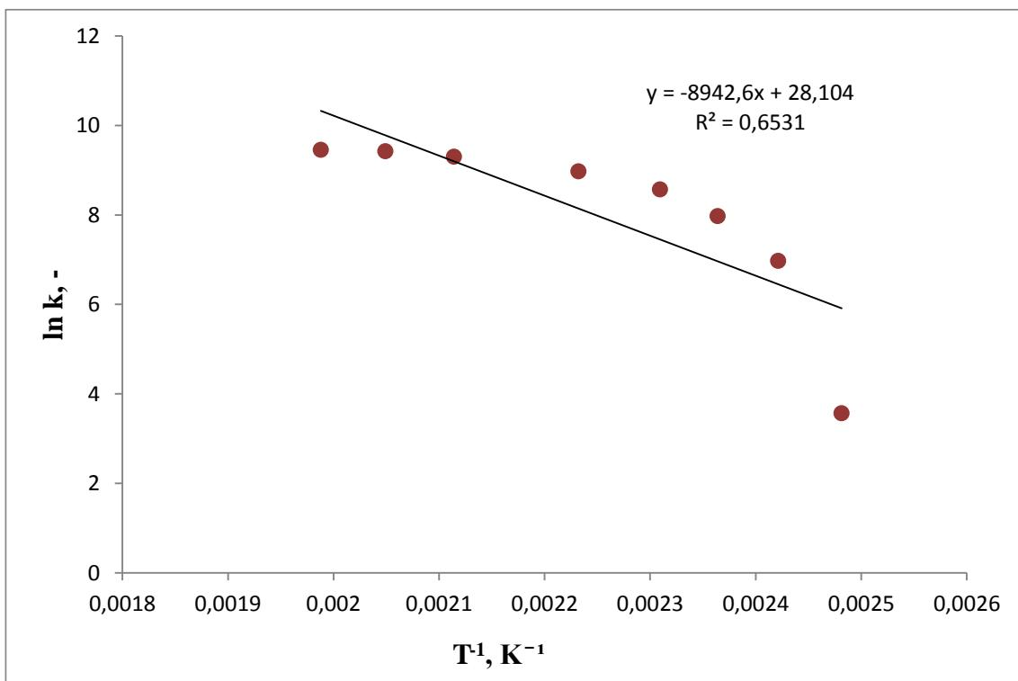
**Slika 5.11.** Grafički test Arrheniusovog izraza za pseudohomogeni model
