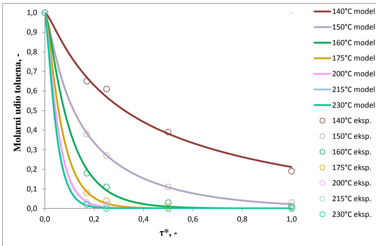
**Slika 5.9.** Usporedba eksperimentalnih rezultata (točke), dobivenih u cijevnom reaktoru sa nepokretnim slojem praškastog katalizatora, s vrijednostima dobivenim prema pretpostavljenom modelu s unutarfaznom difuzijom (linije) za različite temperature
