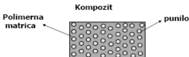
**Slika 9.** Prikaz polimernog kompozita kao višefaznog sustava
