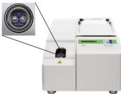
**Slika 39.** Diferencijalni pretražni kalorimetar, Mettler Toledo DSC 823e
