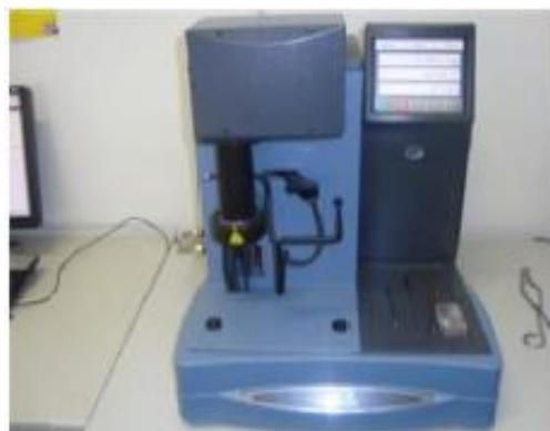
**Slika 33.** Termogravimetar TA Instruments Q 500
