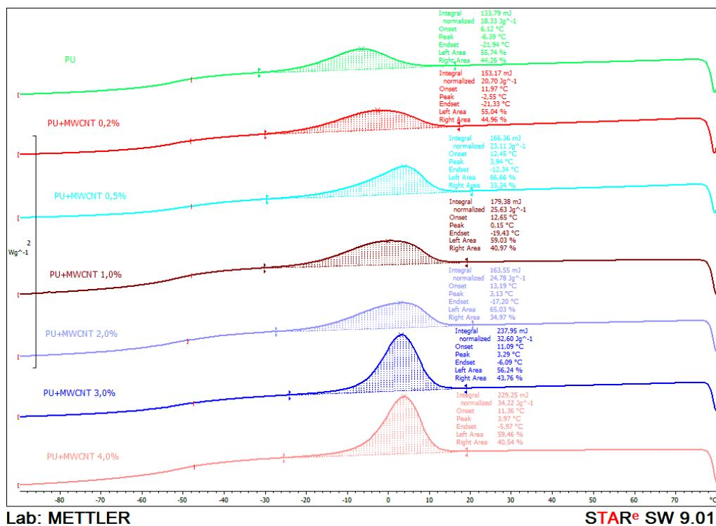
**Slika 56.** Termogrami ciklusa hlađenja za nanokompozitne sustave PU/MWCNT
