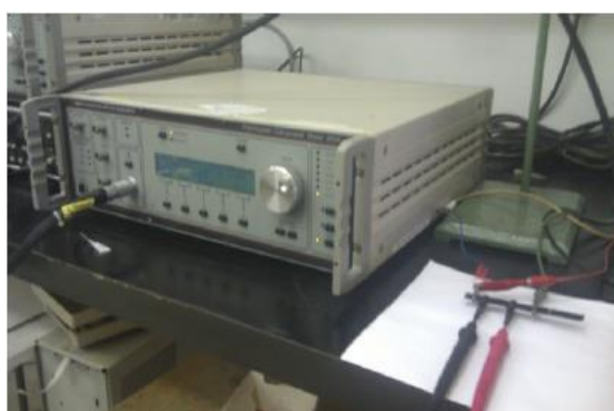
Slika 42. a) Instrument za puštanje struje određene jakosti, b) voltametar i električni krug na uzorku, spajan prema metodi četiri kontakta
