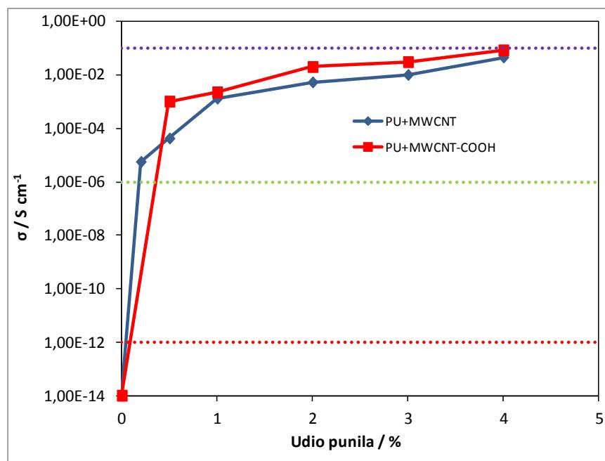
**Slika 81.** Utjecaj masenog udjela punila na specifičnu provodnost nanokompozit; na grafičkom prikazu unesene su i vrijednosti vodljivosti koje materijal treba zadovoljiti za određenu namjenu.
