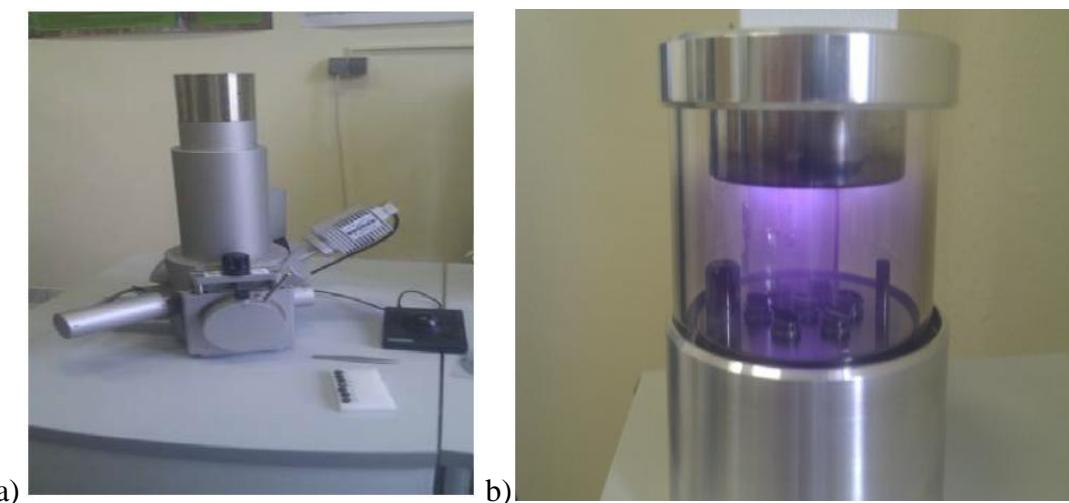
**Slika 35.** a) SEM uređaj Tescan VEGA 3, b) naparivač kojim se nanosi tanki sloj zlata/paladija
