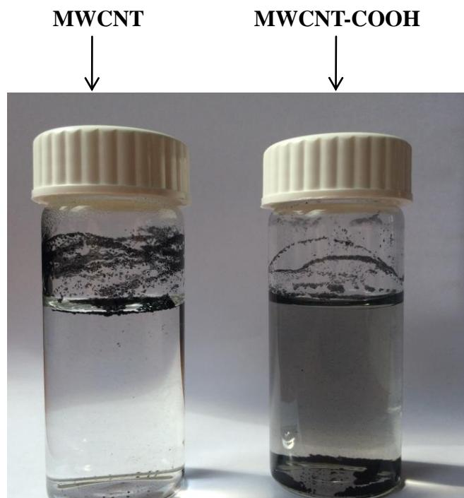
**Slika 51.** Uzorci MWCNT i MWCNT-COOH u vodi
