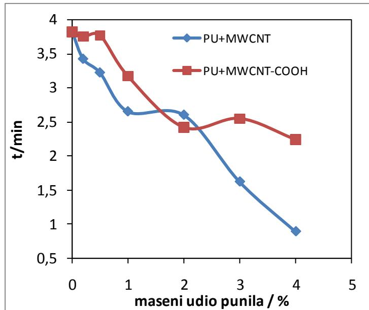
**Slika 68.** Vrijeme maksimuma pika izotermne kristalizacije za sustave PU/MWCNT i PU/MWCNT-COOH
