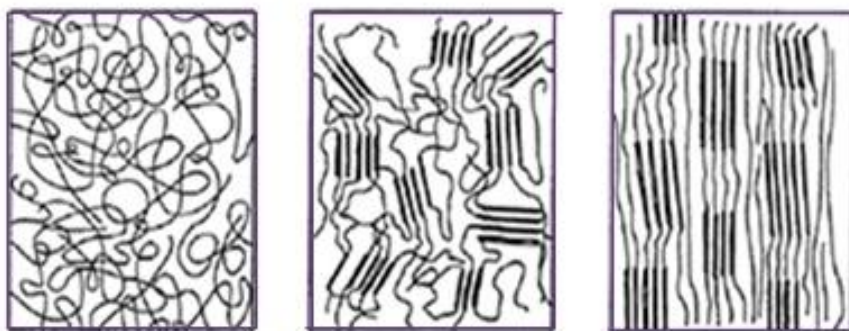
Slika 2. Prikaz podjele polimera prema morfološkoj građi (kristalnosti) s lijeva na desno: amorfna, semikristalna i kristalna struktura
