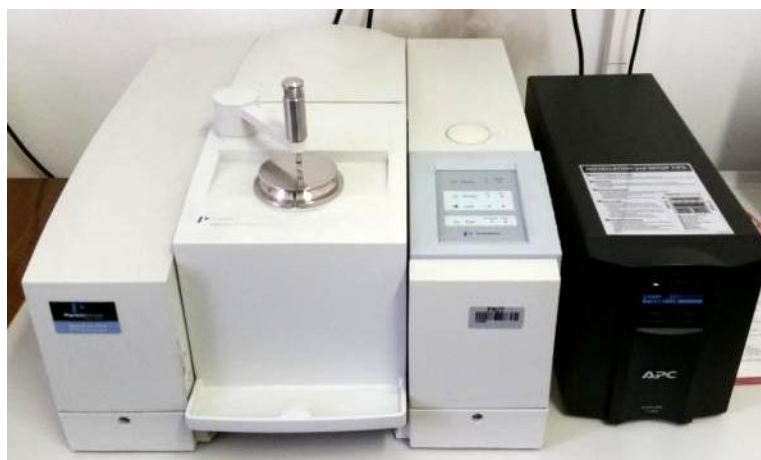
Slika 34. FTIR spektrometar, Perkin Elmer Spectrum One Spectrometers ATR sustavom
