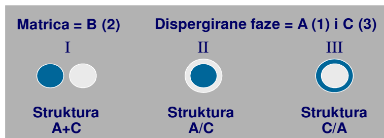
Slika 24. Shematski dijagram tri moguće fazne strukture ternarne mješavine:
