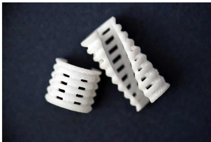
Slika 14. Stent od PCL-a dobiven 3D printanjem, koji služi održavanje prohodnosti dišnih puteva kod novorođenčadi [28]
