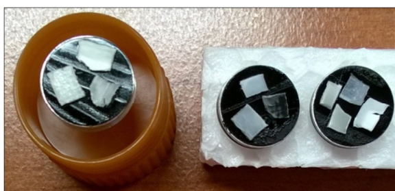
Slika 38. Uzorci na nosačima s ljepljivom trakom prije procesa neparivanja
