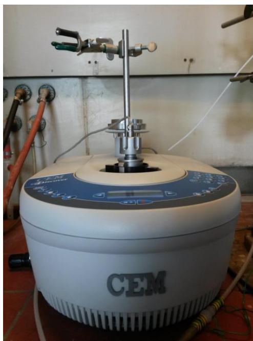
Slika 3.2. Kotlasti reaktor s mikrovalovima
