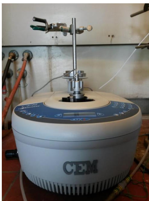
Slika 3.2. Kotlasti reaktor s mikrovalovima
