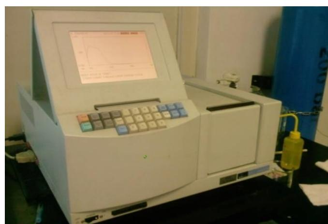
**Slika 3.6.** UV/Vis spektrofotometar
