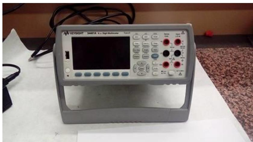
**Slika 3.3.** Uredaj za mjerjenje električnog otpora Keysight 34461 6 1/2 Digit Multimeter
