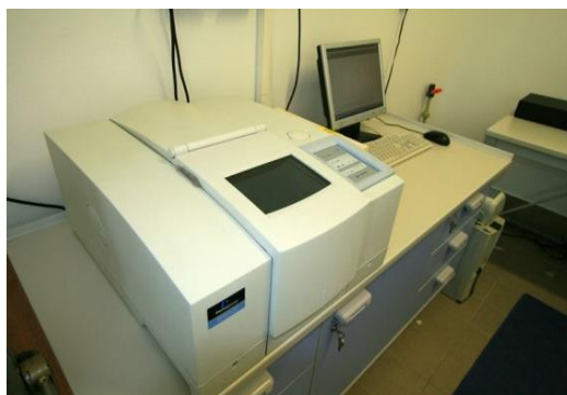
Slika 3.2. Perkin Elmer Spectrum One FTIR spektrometar
