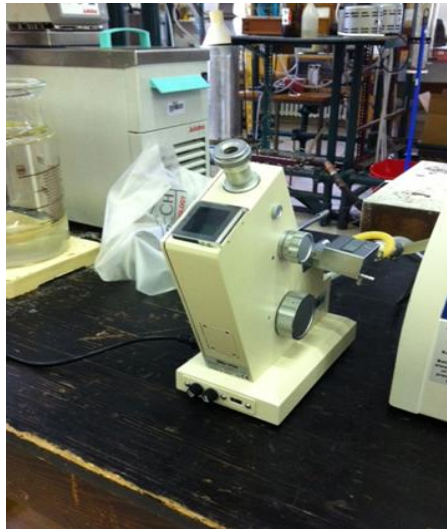
Slika 14. Uređaj za mjerenje indexa loma- refraktometar
