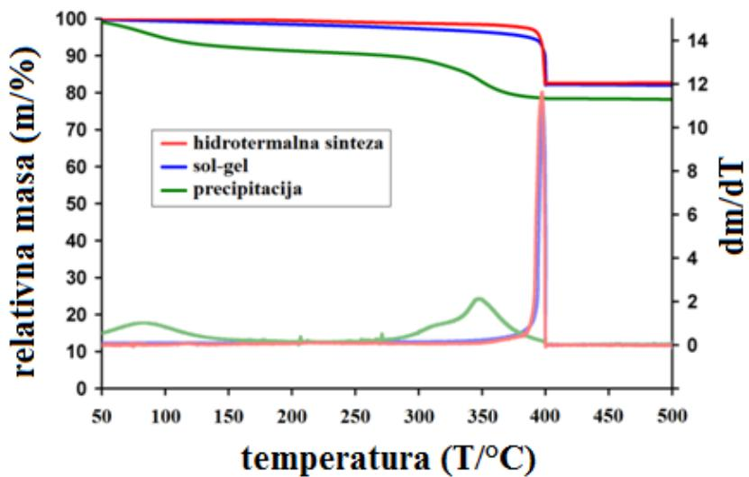
**Slika 4.3.** Termogravimetrijska analiza uzorka  $\text{SnS}_2$  pripremljenih hidrotermalnom, sol-gel metodom i precipitacijom
