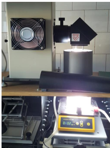
Slika 3.4. Reaktor izložen zračenju solar simulatora
