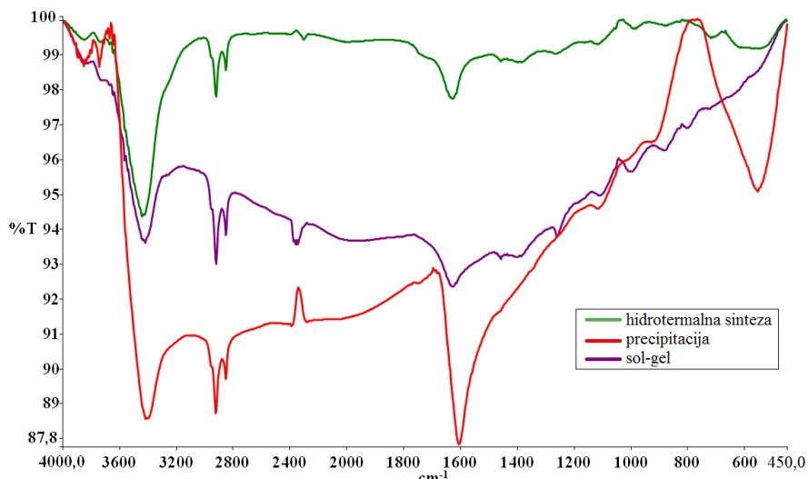
**Slika 4.2.** FTIR spektar uzoraka  $\text{SnS}_2$  pripremljenih hidrotermalnom, sol-gel i precipitacijskom sintezom
