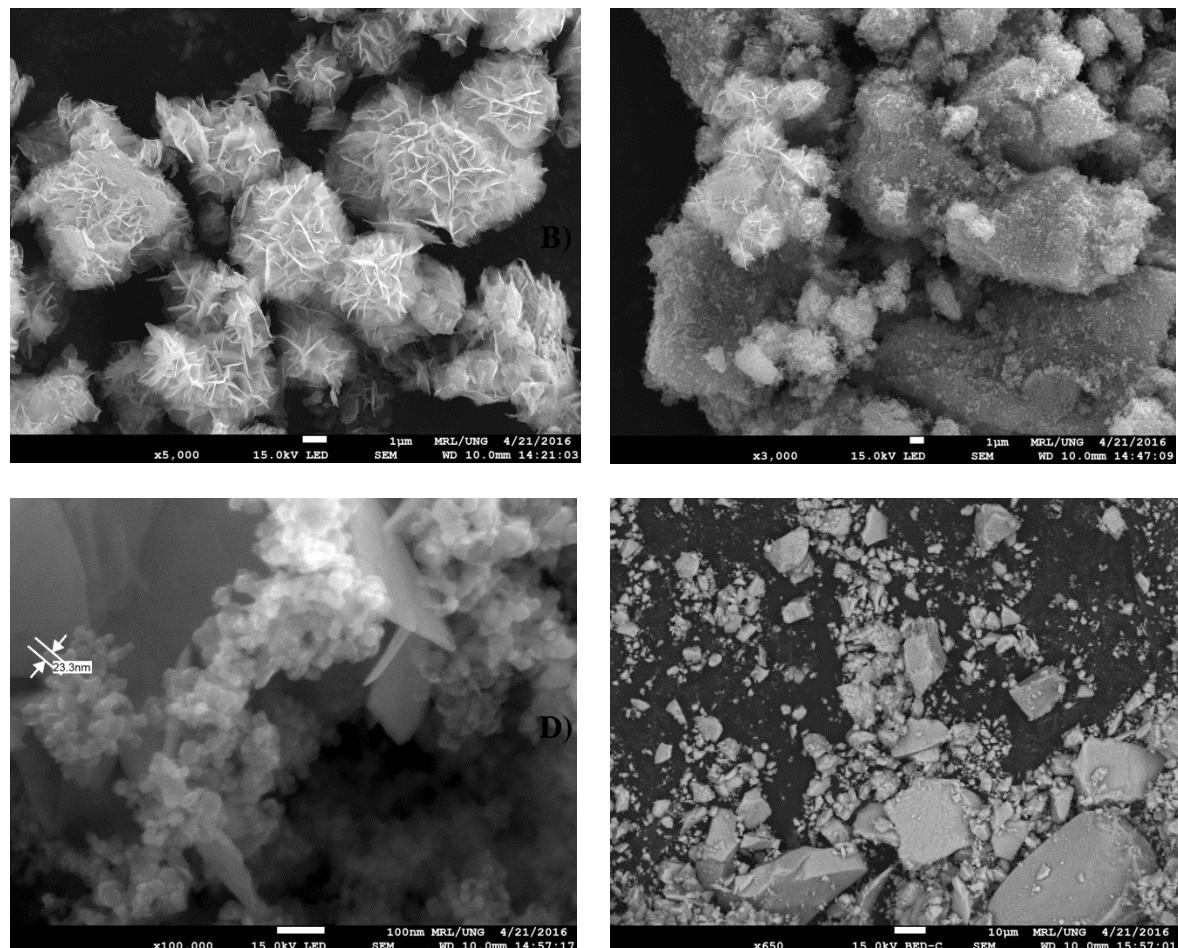
**Slika 4.5.** SEM mikrografije: A) hidrotermalnog  $\text{SnS}_2$ , B) i C) sol-gel  $\text{TiO}_2\text{-SnS}_2$  te D) hidrotermalnog  $\text{TiO}_2\text{-SnS}_2$
