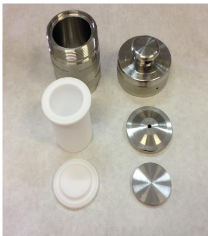
Slika 3.2. Autoklavi korišteni u hidrotermalnoj sintezi
