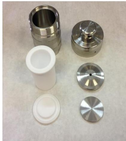
Slika 3.2. Autoklavi korišteni u hidrotermalnoj sintezi
