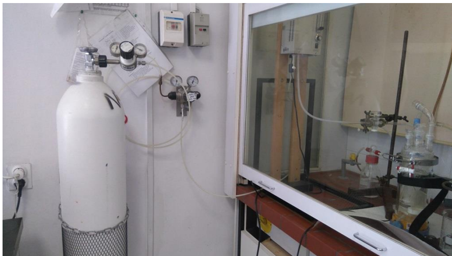
Slika 14. Proces reaktivacije fotokatalizatora \text{TiO}_2\text{-SnS}_2 ozonom
