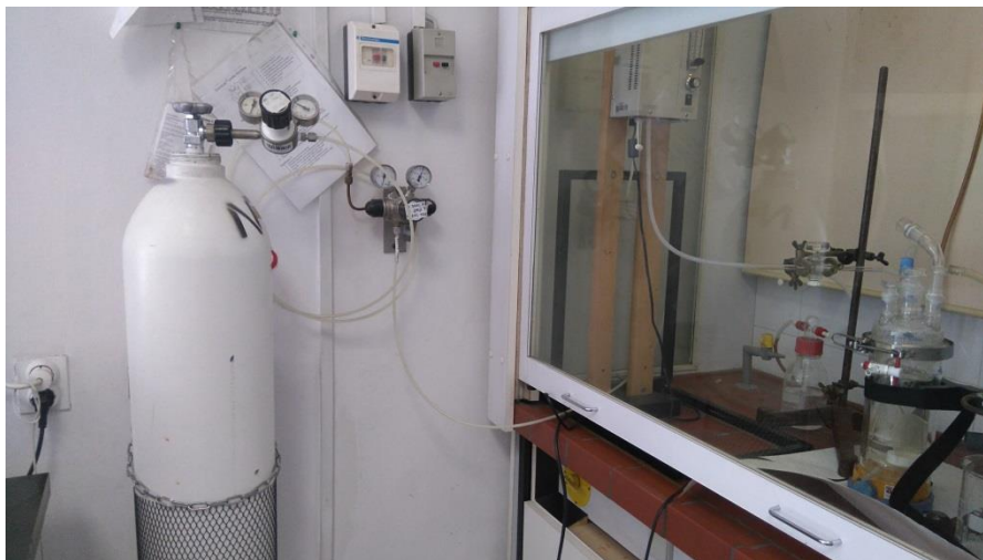
Slika 14. Proces reaktivacije fotokatalizatora \text{TiO}_2\text{-SnS}_2 ozonom
