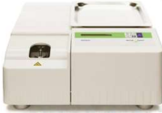
Slika 3.3: DSC uređaj, Mettler Toledo DSC 822e
