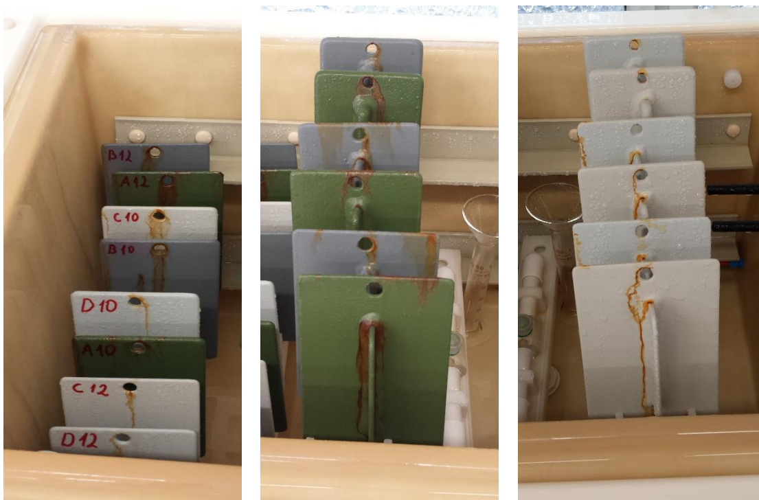
Slika 59. Stanje u slanoj komori nakon otprilike 360 sati
