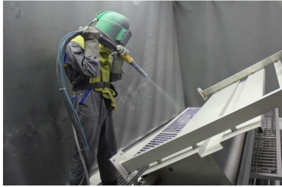
Slika 8. Prikaz mehaničke obrade postupak sačmarenja [14]
