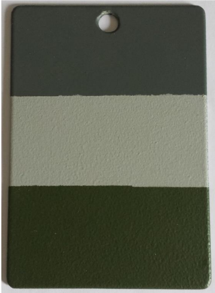
Slika 42. Premazni sustav A po slojevima premaza
