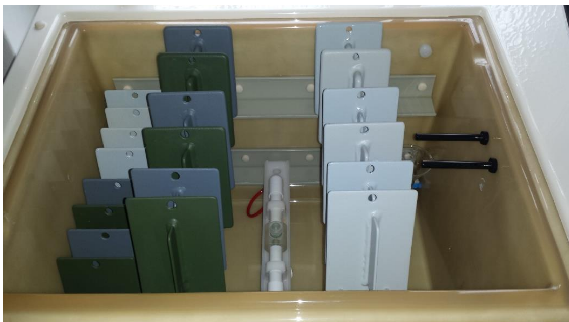
Slika 51. Testne pločice u slanoj komori prije početka ispitivanja
