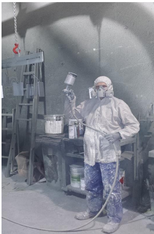
Slika 41. Prikaz procesa nanošenja premaza na testne pločice
