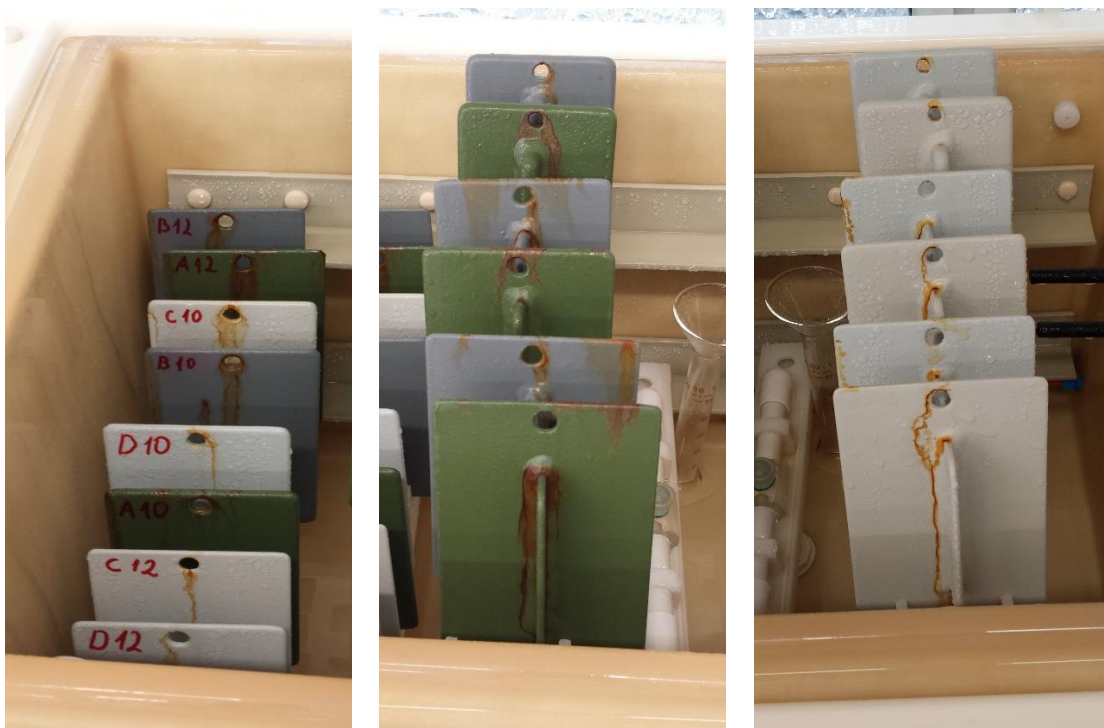
Slika 59. Stanje u slanoj komori nakon otprilike 360 sati
