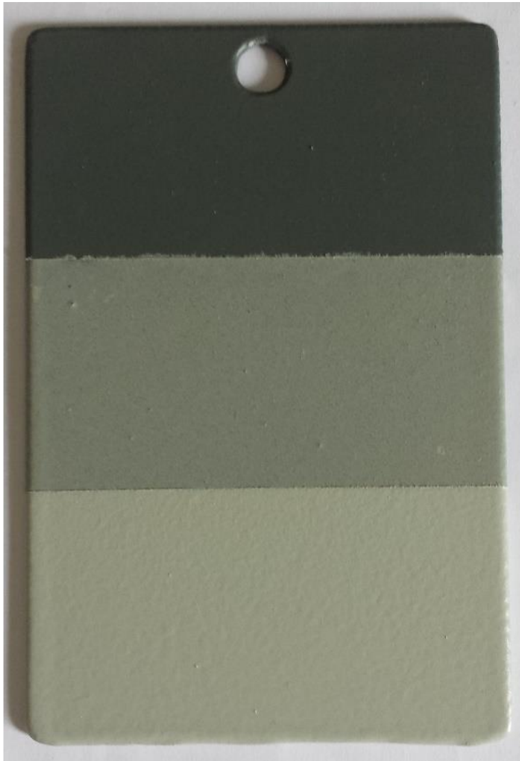
Slika 44. Premazni sustav C po slojevima premaza
