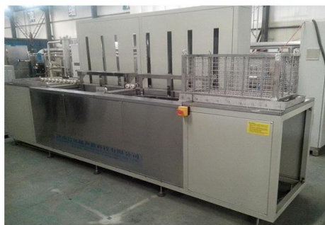
Slika 10. Kupelj za ultrazvučno odmašćivanje [15]
