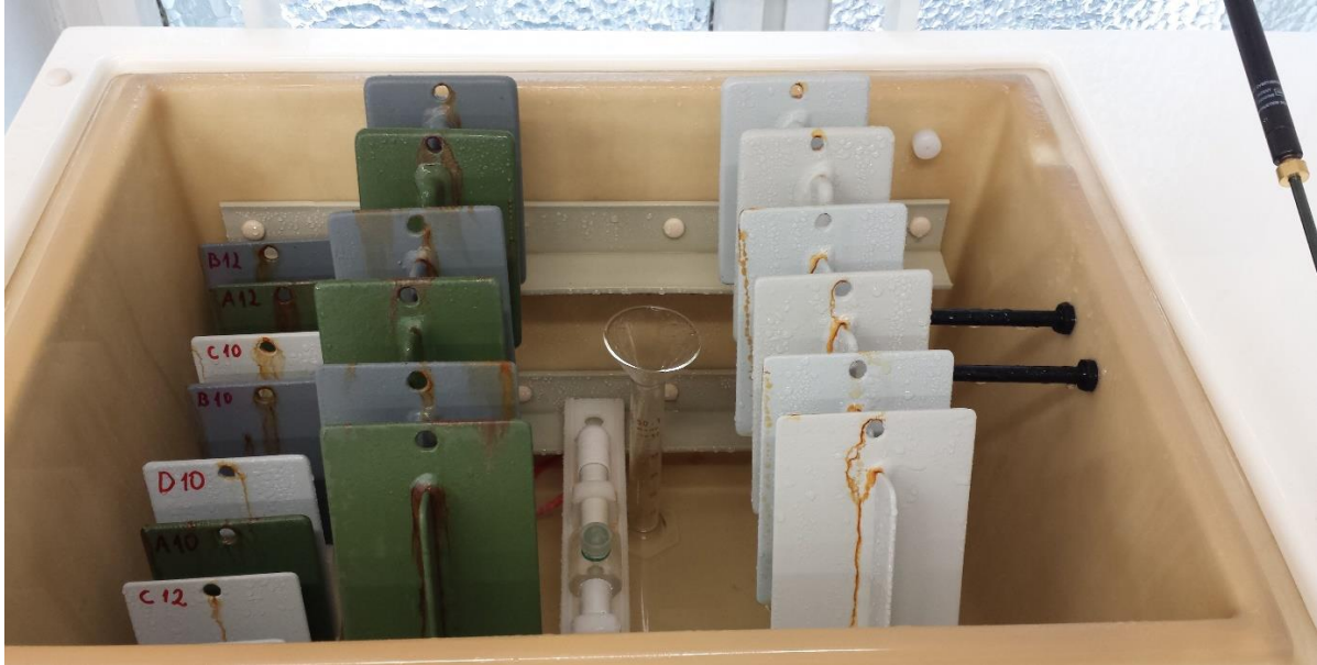
Slika 59. Stanje u slanoj komori nakon otprilike 360 sati
