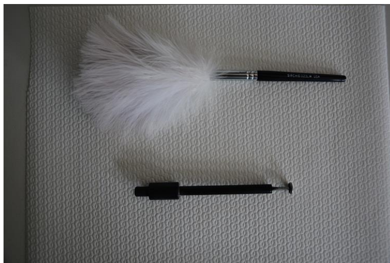
Slika 5. Gore - aplikator sa staklenim vlaknima, dolje - magnetični aplikator.
