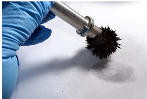
Slika 6. Primjena magnetskog aplikatora [5].
