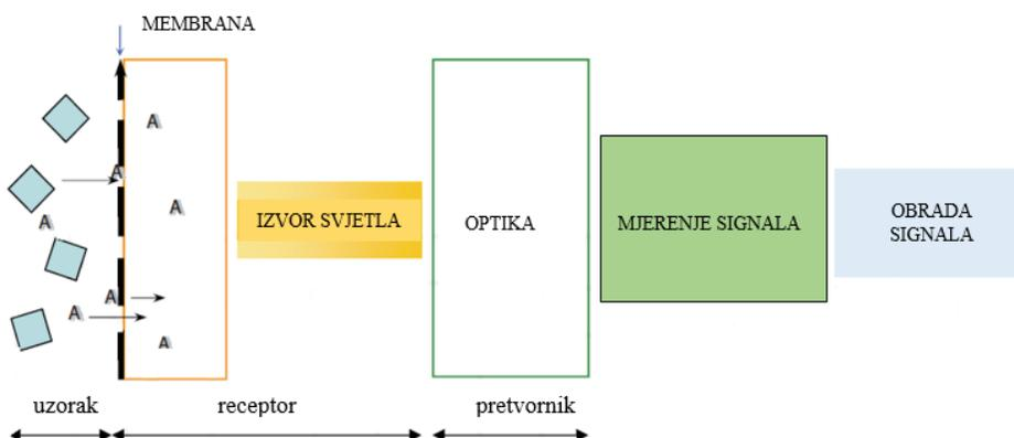
**Slika 1.** Shematski prikaz aparature optičkog kemijskog senzora<sup>[2]</sup>
