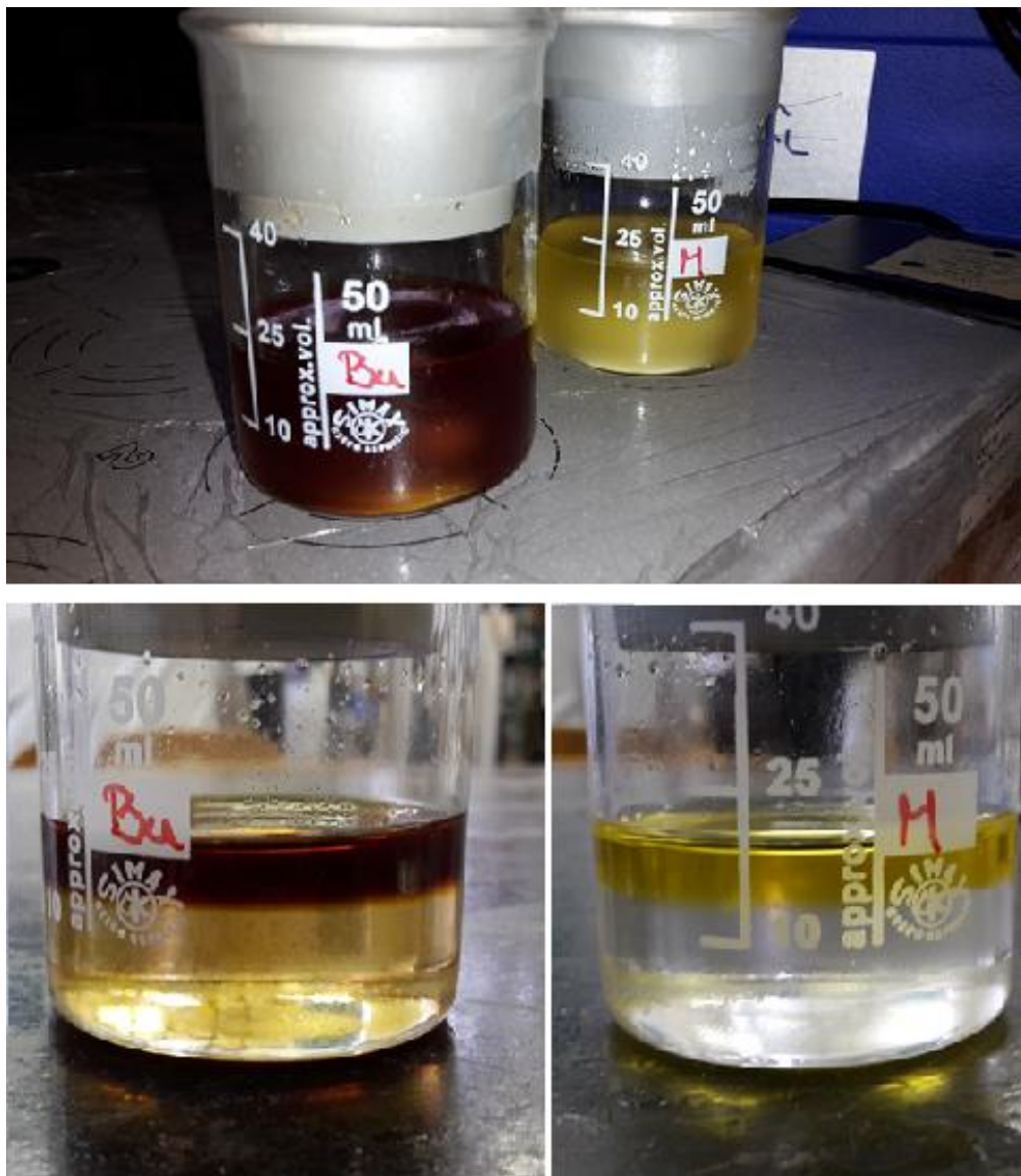
Slika 3.4. Provođenje ekstrakcije bučinog i maslinovog biodizela
