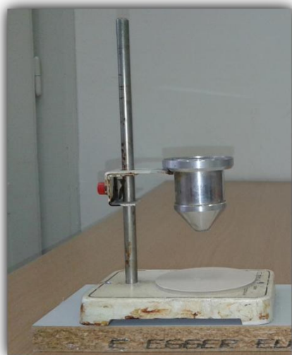
Slika 3.4. Fotografija lijevka za određivanje kuta mirovanja (Zavod za mehaničko i toplinsko procesno inženjerstvo, FKIT).
