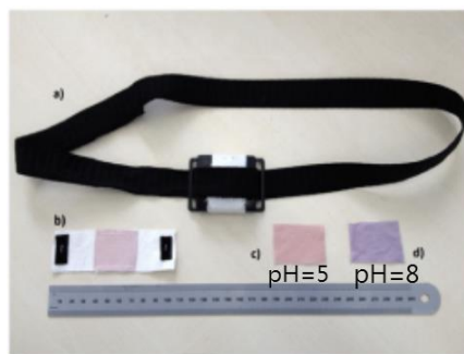
Slika 2.12. pH senzor na tekstilu, [31]
