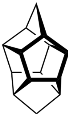
Slika 5. Pentasilna jedinica ZSM-5 zeolita 21
