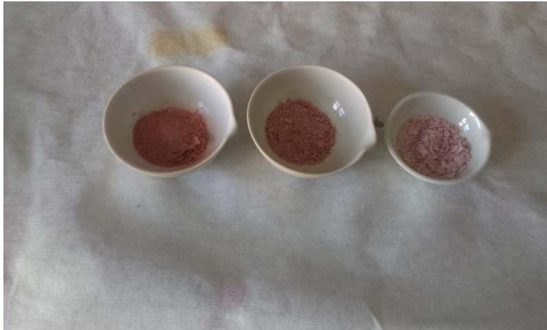
Slika 15. Kompozitni katalizatori s različitim omjerom Fe/ZSM5
