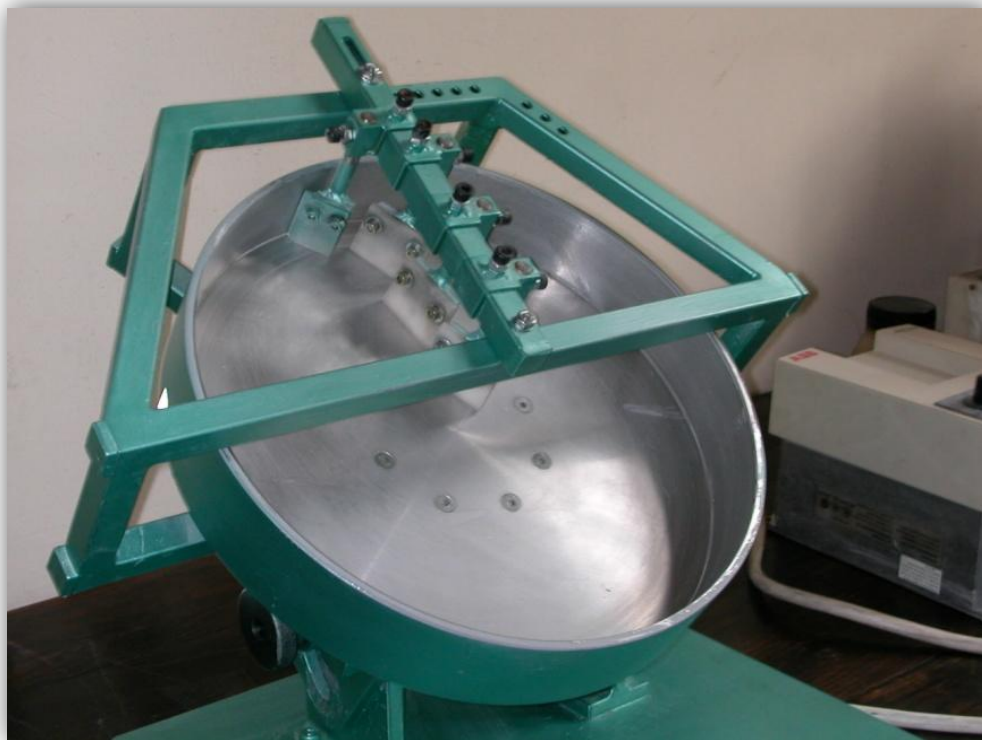
Slika 3.2. Fotografija disk granulatora u laboratorijskom mjerilu (Fakultet kemijskog inženjerstva i tehnologije, Zavod za mehaničko i toplinsko procesno inženjerstvo, Zagreb, Republika Hrvatska).
