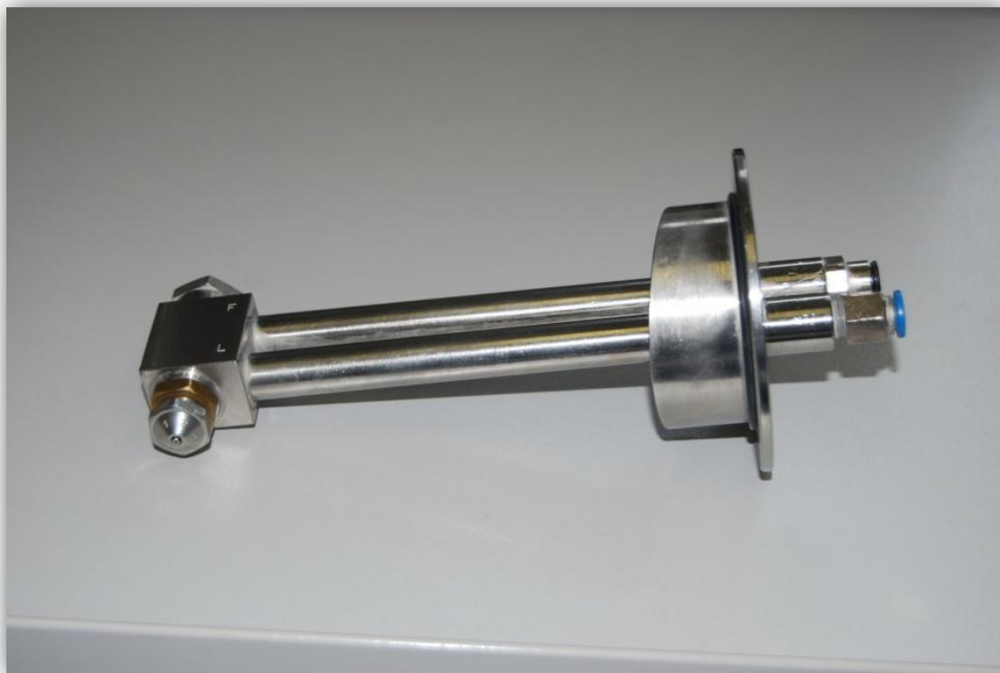
Slika 3.3. Fotografija procesnog elementa za raspršivanje veziva, dvofluidnog raspršivača (Fakultet kemijskog inženjerstva i tehnologije, Zavod za mehaničko i toplinsko procesno inženjerstvo, Zagreb, Republika Hrvatska).
