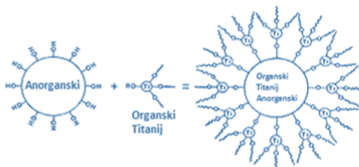
Slika 19. Shematski prikaz prevlačenja punila pomoću titanata
