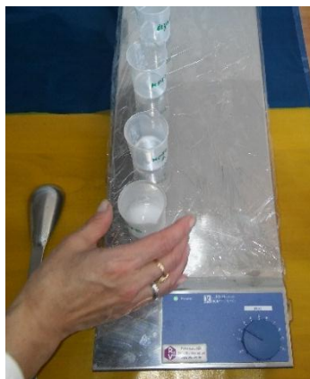
Slika 29. Priprava silana na magnetskoj miješalici
