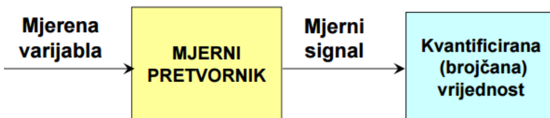
Slika 2-1. Shema rada mjernog pretvornika [2]
