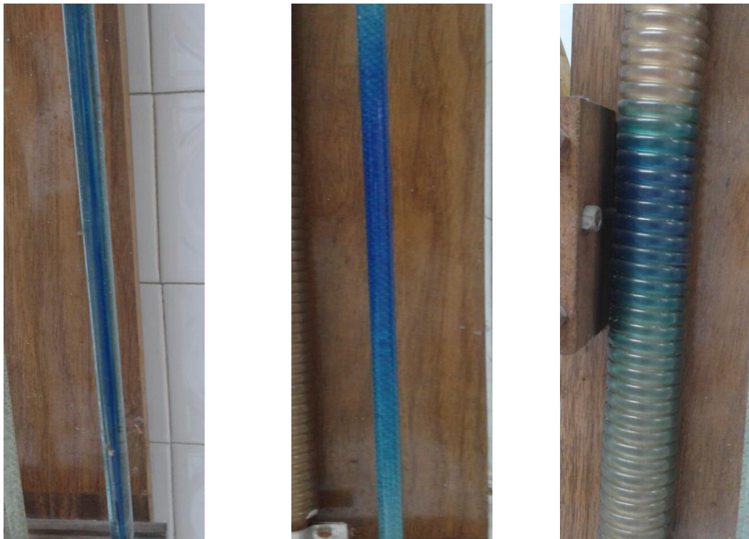
Slika 3.2 Provedba eksperimenta obojenim traserom u a) ravnoj cijevi, b) cijevi sa staklenim kuglicama, c) spiralnoj cijevi
