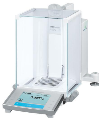
Slika 3.2 Analitička vaga Mettler Toledo XA105DU [18]
