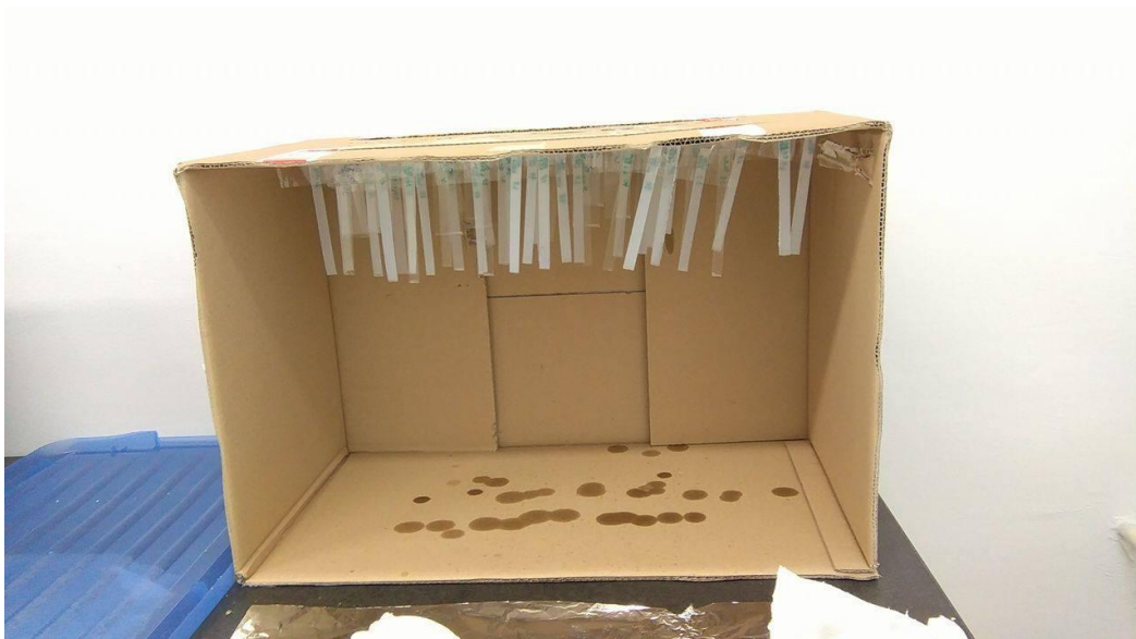
Slika 25. Uzorci polimera sa slojem silana prilikom sušenja na sobnoj temperaturi
