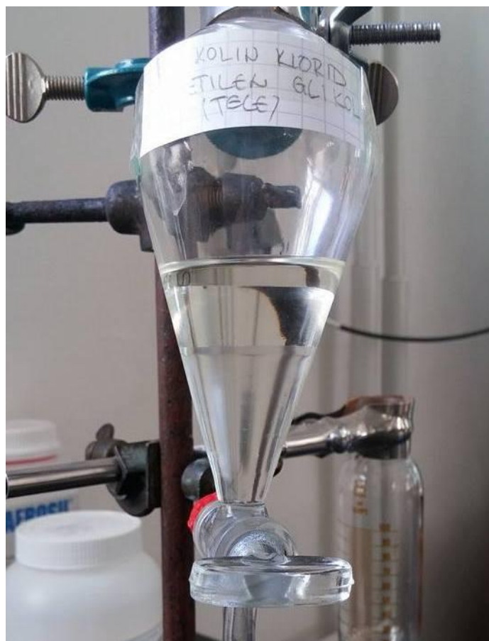
Slika 28. Separacija biodizela i eutektičkog otapala
