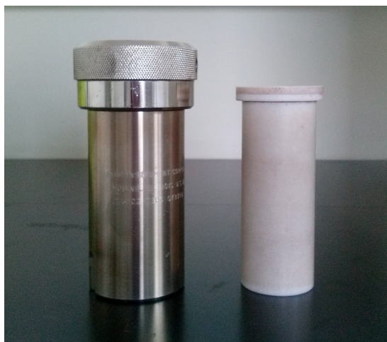
Slika 3.1. Reaktor-autoklav za sintezu i PTFE tuljac.
