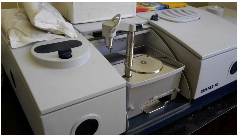
Slika 23. Uređaj za FTIR - Bruker Vertex 70
