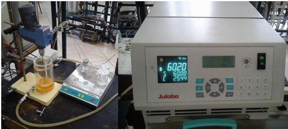
Slika 15. Aparatura za sintezu biodizela
