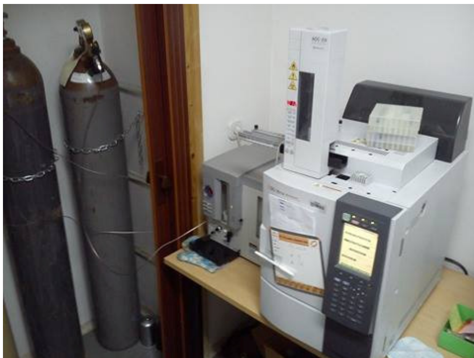
Slika 22. Plinski kromatograf Shimadzu GC-2014
