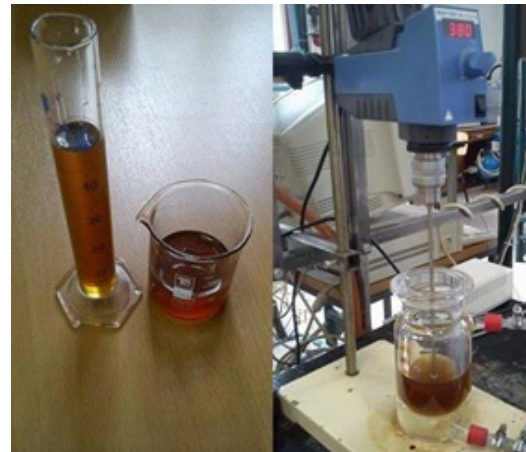
Slika 17. Sinteza biodizela iz OPU
