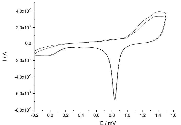
Slika 31. Čišćenje zlatne elektrode u  $0,1 \text{ mol dm}^{-3}$  otopini perklorne kiseline uz brzinu promjene potencijala,  $v = 50 \text{ mV s}^{-1}$ .
