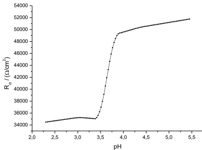
**Slika 44.** Ovisnost otpora prijelaza naboja o pH za Au/NAC modificiranu elektrodu
