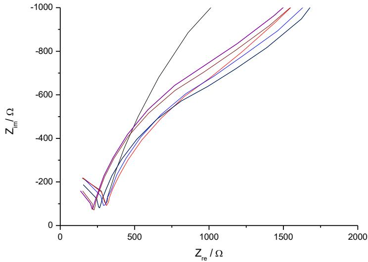
**Slika 37.** Nyquistov prikaz impedancije koje su snimljene u  $10 \text{ mmol dm}^{-3}$  otopinama  $[\text{Fe}(\text{CN})_6]^{3-} / [\text{Fe}(\text{CN})_6]^{4-}$  u rasponu pH vrijednosti manjim od 5,446.
