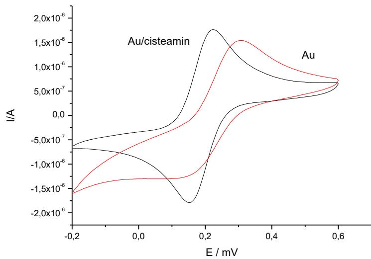
**Slika 34.** Au i Au/CSA elektroda u acetatnom puferu, pH = 4,5 uz  $10 \text{ mmol dm}^{-3}$  otopine  $[\text{Fe}(\text{CN})_6]^{3-}$  i  $[\text{Fe}(\text{CN}_6)]^{4-}$ , uz brzinu promjene potencijala,  $v = 50 \text{ mV s}^{-1}$ .
