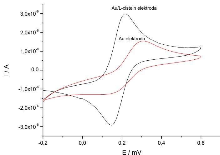
**Slika 46.** Ciklički voltamogrami za Au i Au/CYS elektrodu u kiselom puferu, pH = 4,5 uz 10 mmol dm<sup>-3</sup> otopine [Fe(CN)<sub>6</sub>]<sup>3-</sup> i [Fe(CN)<sub>6</sub>]<sup>4-</sup>. Brzina promjene potencijala, v = 50 mV s<sup>-1</sup>.
