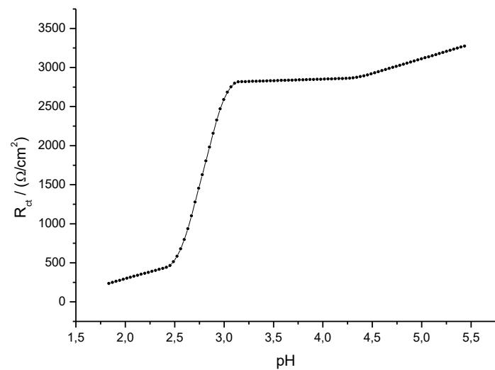
**Slika 49.** Ovisnost otpora prijelaza naboja o pH za Au/CYS modificiranu elektrodu.
