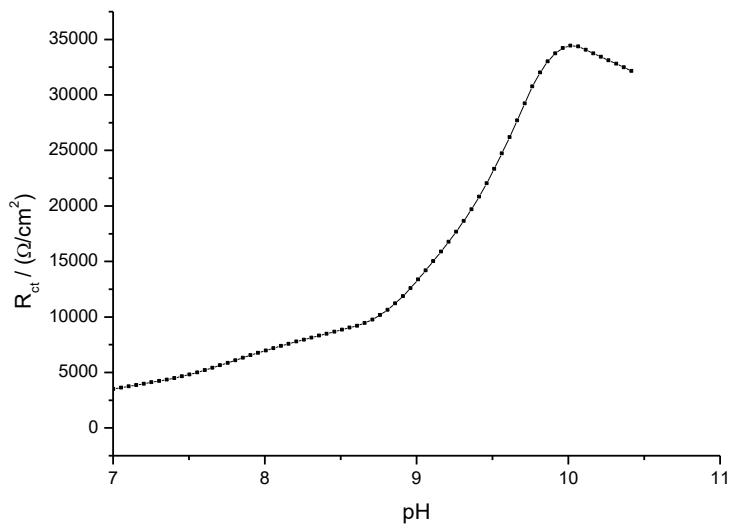
**Slika 39.** Vrijednosti otpora prijelazu naboja u ovisnosti o pH za Au/CSA modificiranu elektrodu dobiveni interpolacijom pomoću računalnog programa *Origin*.
