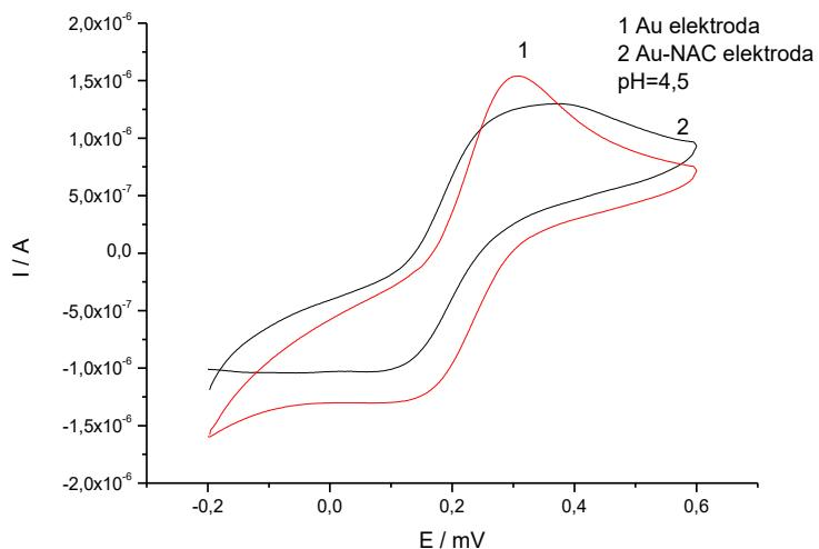
**Slika 41.** Au i Au/NAC elektroda u acetatnom puferu, pH = 4,5 uz  $10 \text{ mmol dm}^{-3}$  otopine  $[\text{Fe}(\text{CN})_6]^{3-}$  i  $[\text{Fe}(\text{CN}_6)]^{4-}$ , uz brzinu promjene potencijala,  $v = 50 \text{ mV s}^{-1}$
