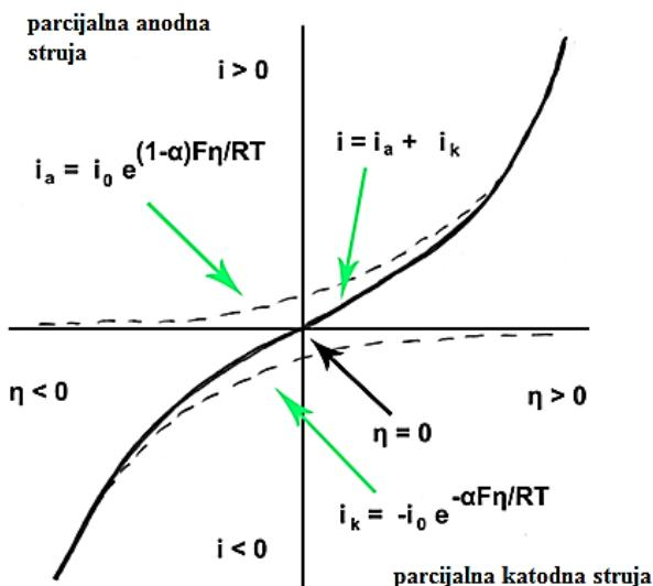
Slika 8. Struja-potencijal krivulja prema Butler-Volmerovoj jednadžbi elektrokemijske kinetike<sup>[13]</sup>.
