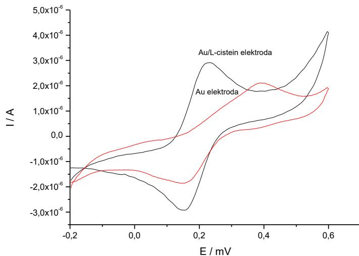
**Slika 47.** Ciklički voltamogrami za Au i Au/CYS elektrodu bazičnom puferu, pH = 8,5 uz 10 mmol dm<sup>-3</sup> otopine [Fe(CN)<sub>6</sub>]<sup>3-</sup> i [Fe(CN)<sub>6</sub>]<sup>4-</sup>. Brzina promjene potencijala, v = 50 mV s<sup>-1</sup>.
