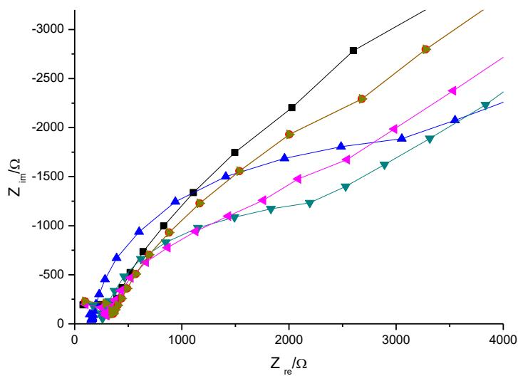
**Slika 48.** Nyquistov prikaz impedancije koje su snimljene u 10 mmol dm<sup>-3</sup> otopinama [Fe(CN)<sub>6</sub>]<sup>3-</sup> / [Fe(CN)<sub>6</sub>]<sup>4-</sup> u rasponu pH vrijednosti od 1,834 do 5,446 za modificiranu Au/CYS elektrodu.
