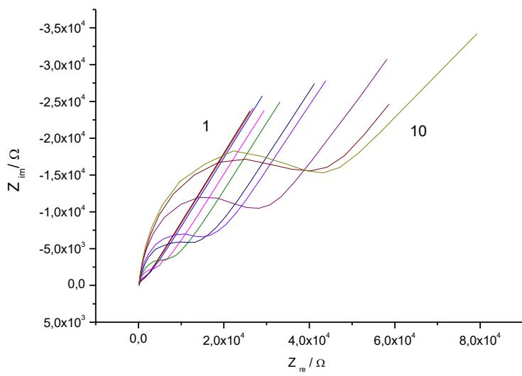
**Slika 36.** Nyquistov prikaz impedancije koje su snimljene u  $10 \text{ mmol dm}^{-3}$  otopinama  $[\text{Fe}(\text{CN})_6]^{3-} / [\text{Fe}(\text{CN})_6]^{4-}$  u rasponu pH vrijednosti od 5,446 (1) do 10,416 (10) za Au/CSA modificiranu elektrodu.
