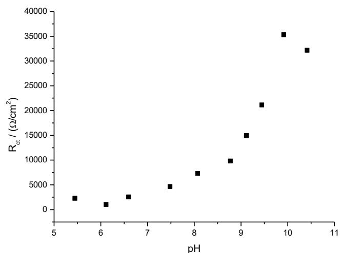
**Slika 38.** Ovisnost otpora prijalaza naboja o pH za Au/CSA modificiranu elektrodu.
