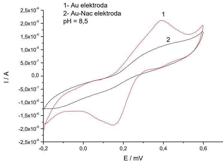
**Slika 42.** Au i Au/NACelektroda u amonijačnom puferu, pH = 8,5 uz 10 mmol dm<sup>-3</sup> otopine [Fe(CN)<sub>6</sub>]<sup>3-</sup> i [Fe(CN)<sub>6</sub>]<sup>4-</sup>, snimljeno uz brzinu promjene potencijala,  $v = 50 \text{ mV s}^{-1}$ .
