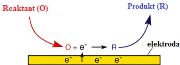
Slika 7. Mehanizam odvijanja elektrokemijske reakcije<sup>[12]</sup>.
