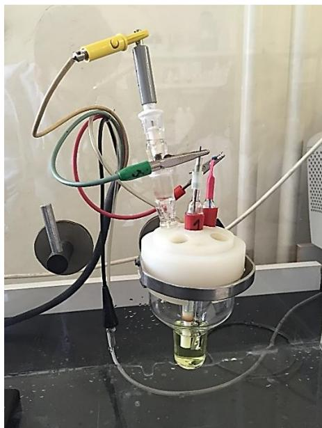
**Slika 29.** Elektrokemijska čelija s troelektrodnim sustavom.
