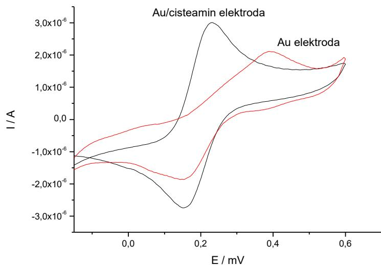
**Slika 35.** Au i Au/CSA elektroda u amonijačnom puferu, pH = 8,5 uz 10 mmol dm<sup>-3</sup> otopine [Fe(CN)<sub>6</sub>]<sup>3-</sup> i [Fe(CN)<sub>6</sub>]<sup>4-</sup>, uz brzinu promjene potencijala,  $v = 50 \text{ mV s}^{-1}$ .
