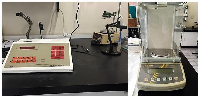
**Slika 28.** pH-metar za mjerjenje pH puferskih otopina (lijevo) i analitička vaga (desno).
