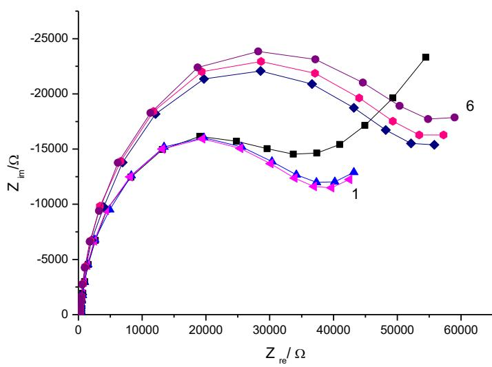
**Slika 43.** Nyquistov prikaz impedancija za Au/NAC elektrodu koje su snimljene u  $10 \text{ mmol dm}^{-3}$  otopinama  $[\text{Fe}(\text{CN})_6]^{3-} / [\text{Fe}(\text{CN})_6]^{4-}$  u rasponu pH vrijednosti od 2,303(1) do 5,446(6).
