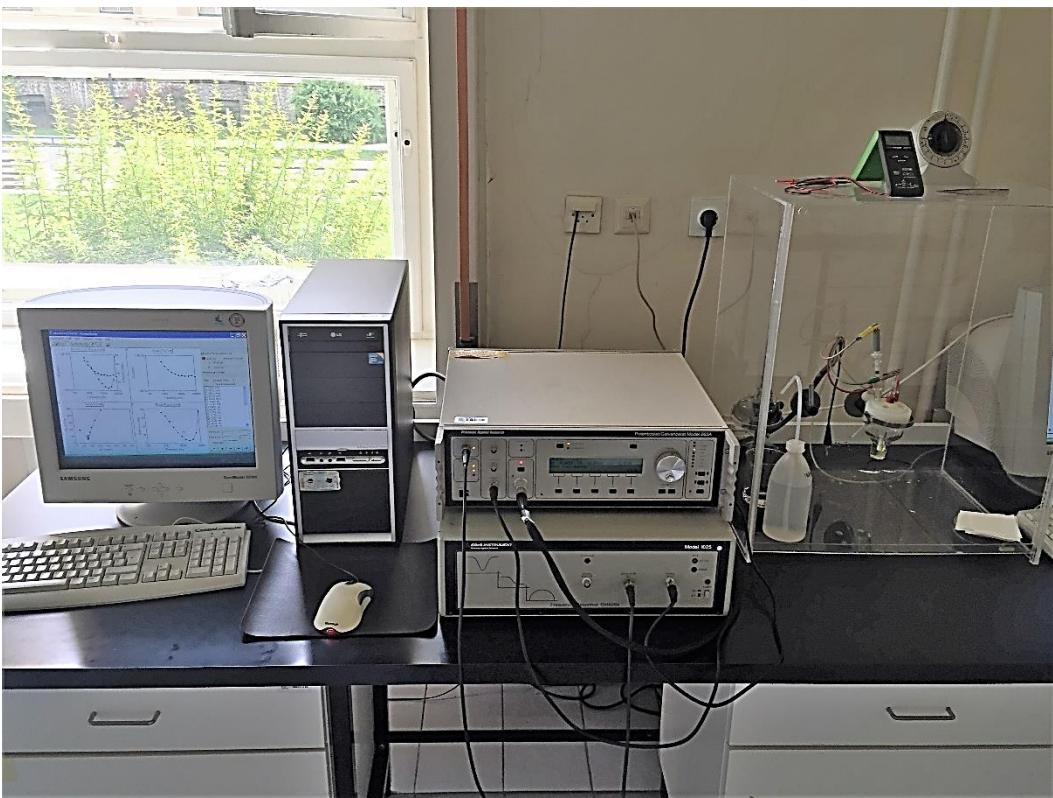
**Slika 30.** Mjerni uređaj koji je korišten za mjerjenje cikličkom voltametrijom i elektrokemijskom impedancijskom spektroskopijom.
