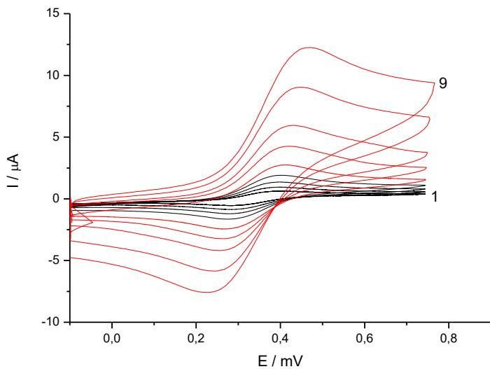
**Slika 32.** Ciklički voltamogrami snimljeni pri različitim brzinama promjene potencijala. Kao elektrolit rabljena je otopina fosfatnog pufera pH = 7,01 te 10 mM otopine kalijeva heksacianoferata(II) i kalijeva heksacianoferata(III). Brzine promjene potencijala: 5 (1), 10, 20, 30, 100, 200, 300, 500, 1000 mV s<sup>-1</sup> (9).
