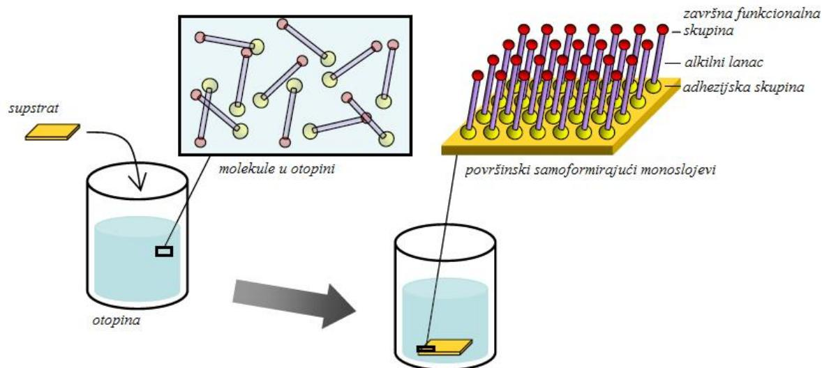
**Slika 20.** Shematski prikaz pripreme površinski samoformirajućih monoslojeva na površini supstrata<sup>[23]</sup>.
