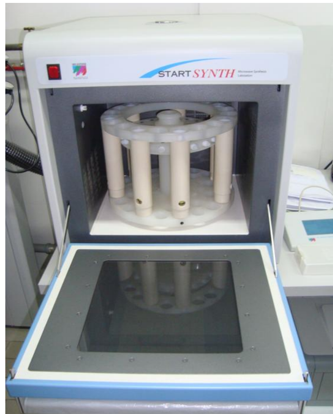
Slika 16. Reaktor s mikrovalnim zračenjem
