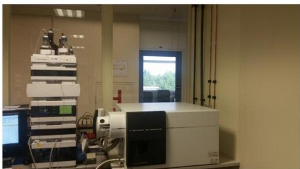
**Slika 3.6.** Tekućinski kromatograf UHPLC (Agilent Series 1290) sa spektrometrom masa
