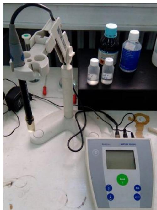
**Slika 3.4.** pH-metar Mettler Toledo
