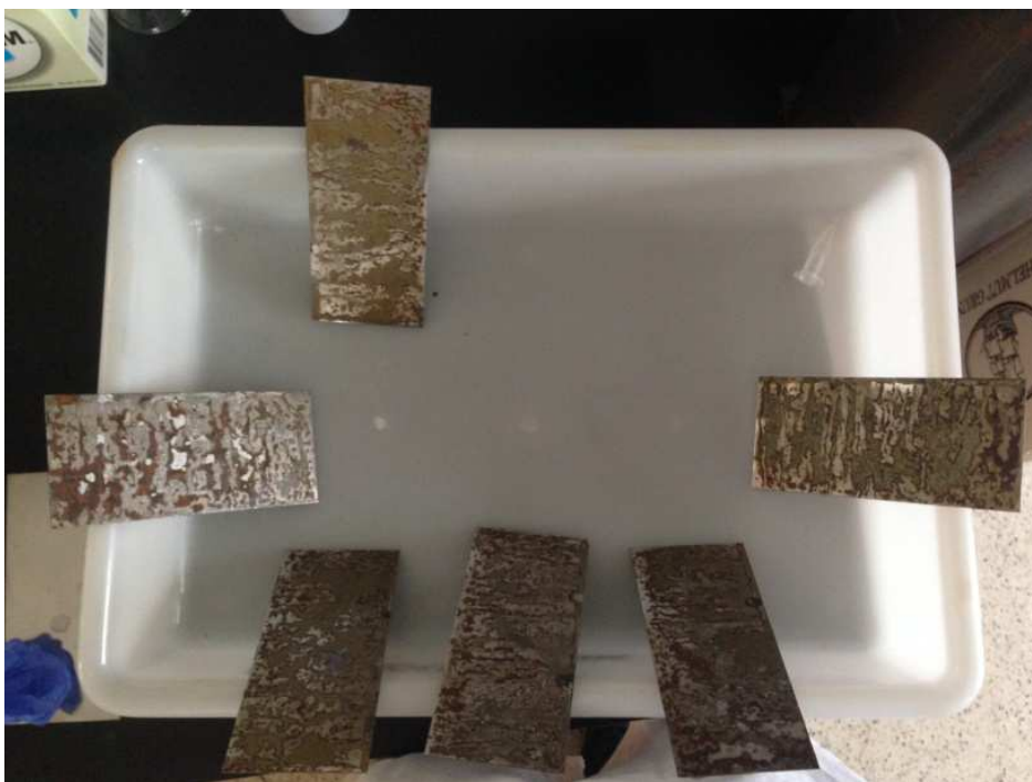
Slika 9. Polirani uzorci nakon mehaničkog čišćenja
