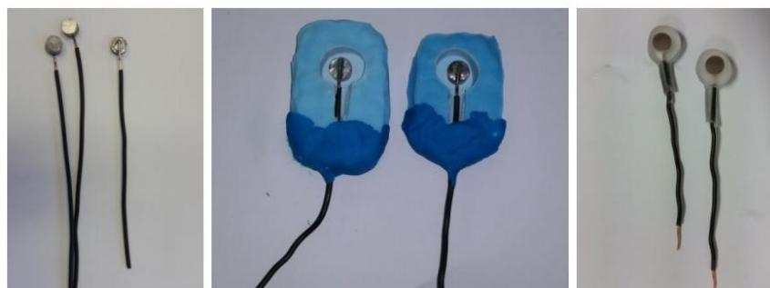
**Slika 10.** Priprema radnih elektroda
