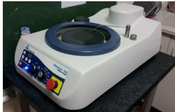
**Slika 11.** Uredaj za poliranje Buehler Meta Serv 250 Grinder - Polisher
