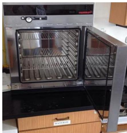
**Slika 13. Peć za sušenje**
