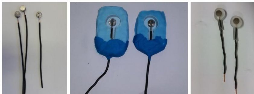
Slika 10. Priprema radnih elektroda
