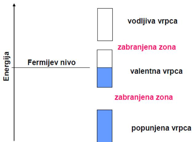
Slika 1. Shematski prikaz energijskih vrpci u čvrstom tijelu ( metalu). [3]
