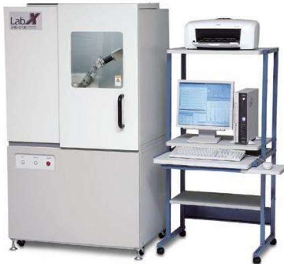
Slika 17. Shimatzu XRD 6000 difraktometar [31]
