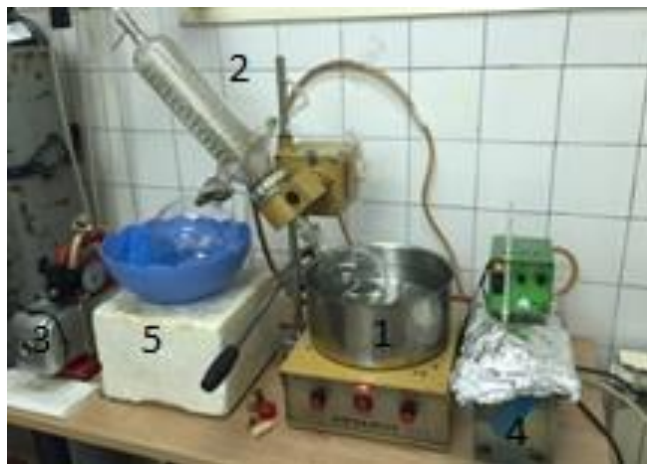
Slika 3.8. Aparatura za vakuum evaporaciju koja se sastoji od: 1) vodena kupelj s tikvicom, 2) sustav za hlađenje, 3) vakuum pumpa, 4) vodena kupelj niske temperature, 5) hladna vodena kupelj s tikvicom
