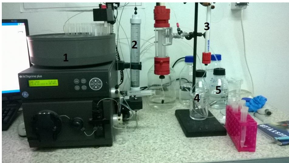
Slika 3.2. Uređaj za preparativnu kromatografiju koji se sastoji od: 1) epruvete s frakcijama, 2) kolona s uzorkom, 3) kolona s punilom, 4) eluent A, 5) eluent B
