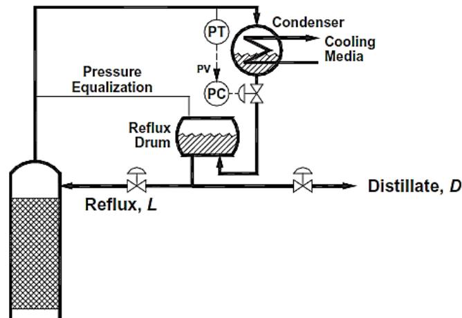
*Slika 2.20 .-Regulacija tlaka djelomičnim potapanjem kondenzatora [3]*
