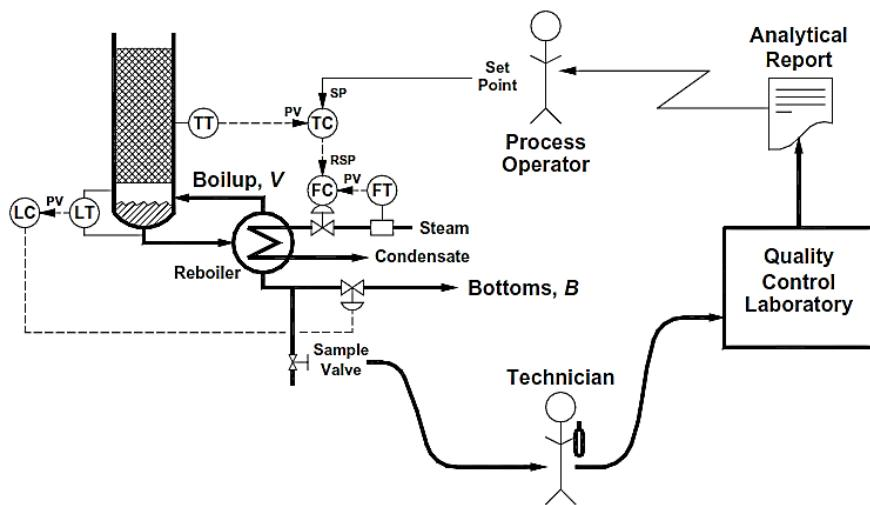
Slika 2.22. -Regulacija sastava produkta dna mjeranjem temperature [1]
