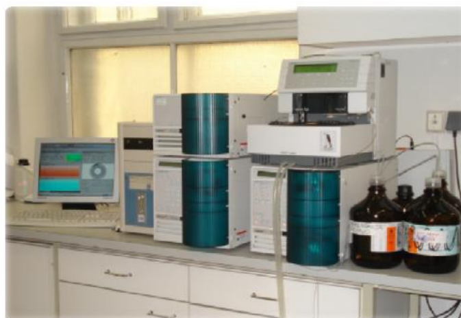
Slika 10. Tekućinski kromatograf visoke djelotvornosti, Varian ProStar 500, s detektorom s nizom dioda (HPLC - DAD)
